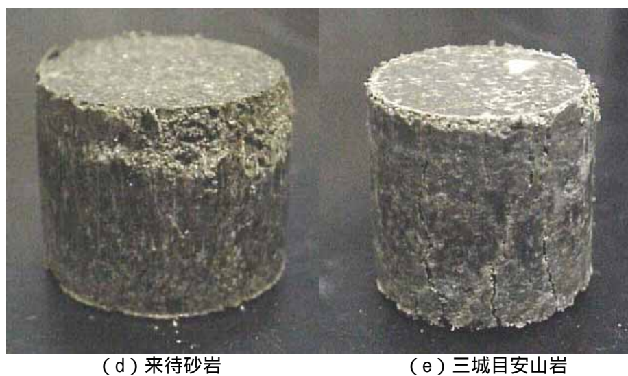
図3-6 押し込み試験後に厚肉円筒から取り出した試験片(湿潤状態).
