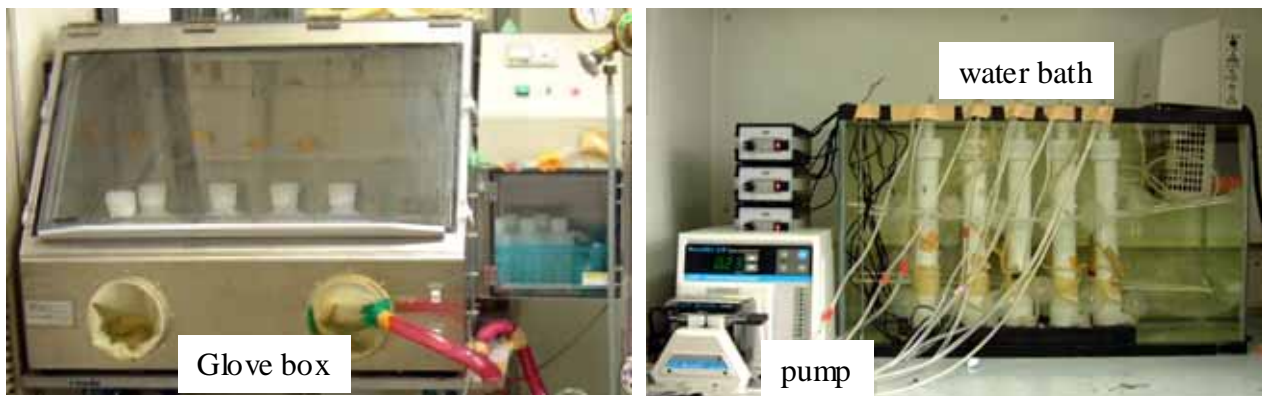
図-6 本研究で用いたフロースルー実験系の概念図および写真
