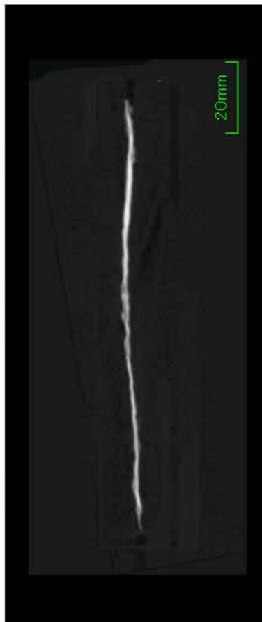
図 3-7 小形鉄錠 (No.256) の外観とX線CT像
