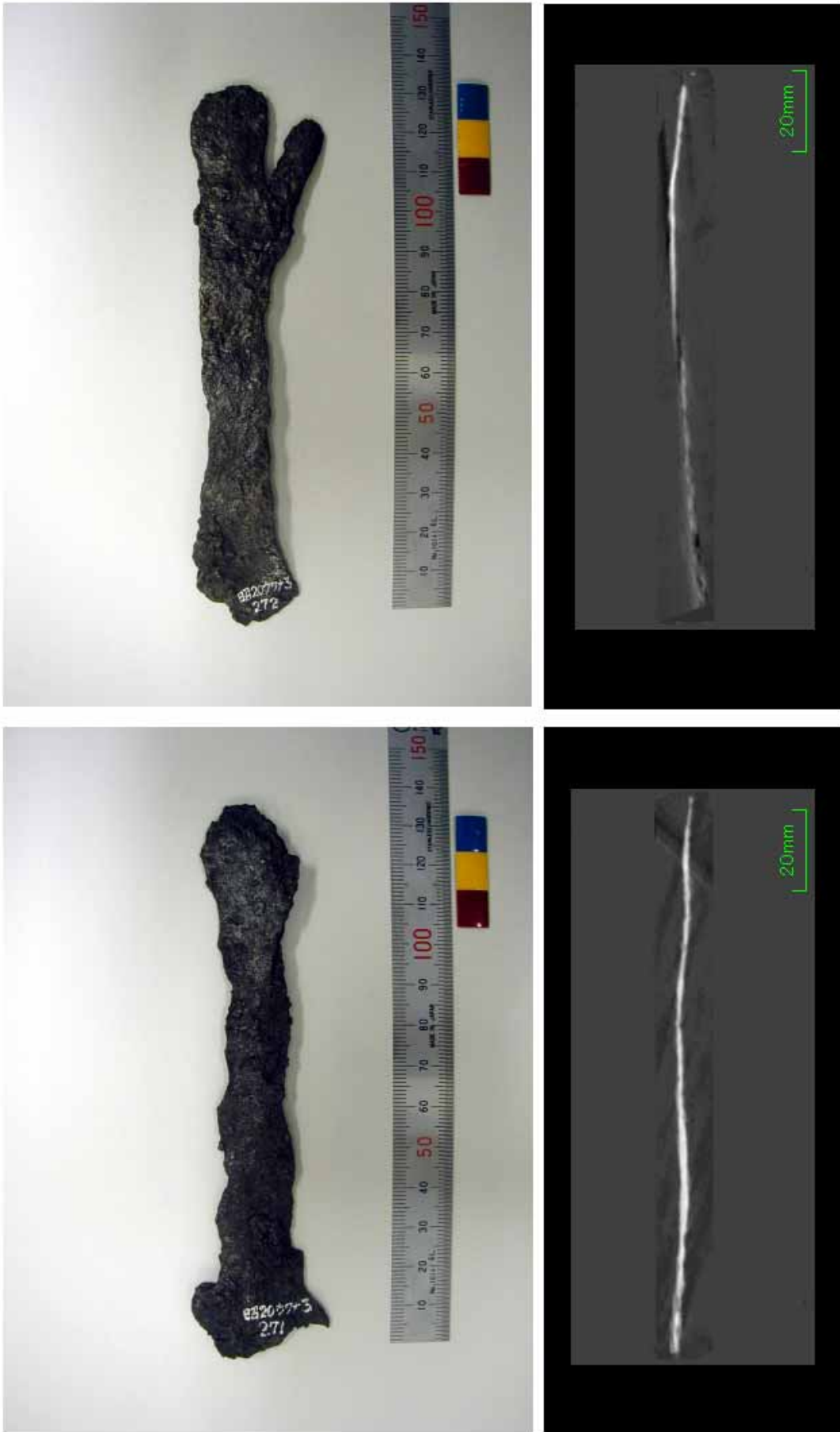
図 3-13 小形鉄鋌 (No.272) の外観とX線CT像
