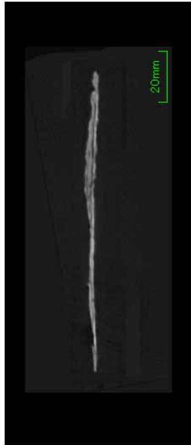
図 3-8 小形鉄錠 (No.257) の外観とX線CT像
