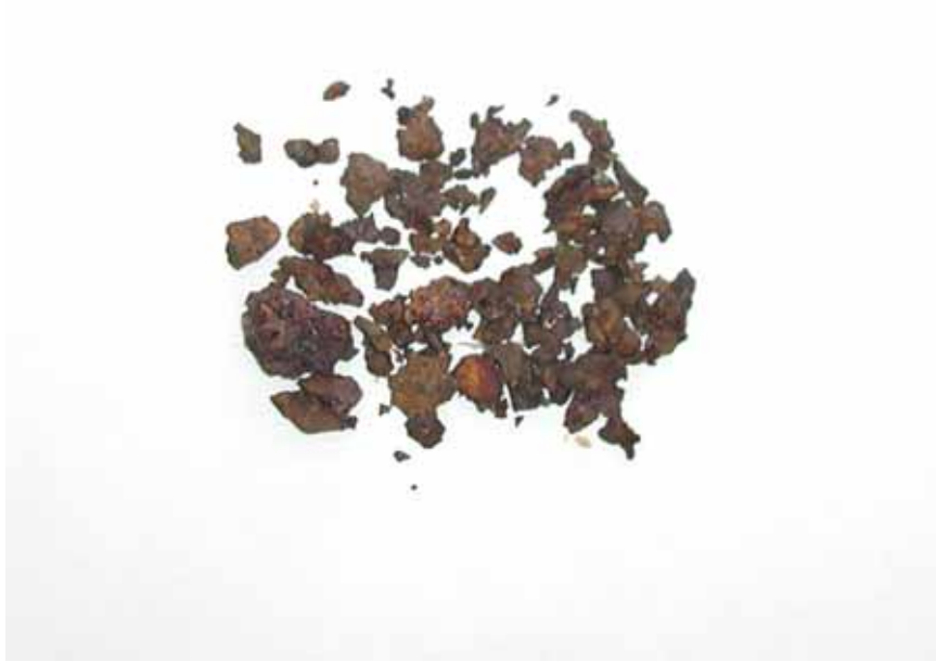
図 3-21 大形鉄釘（No.232）表面錆層の外観
