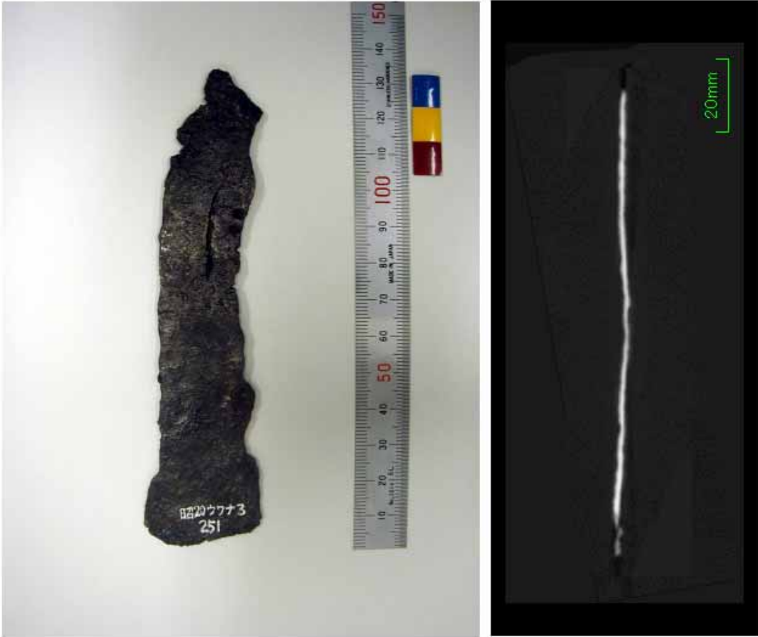
図 3-5 小形鉄鋌 (No.251) の外観とX線CT像
