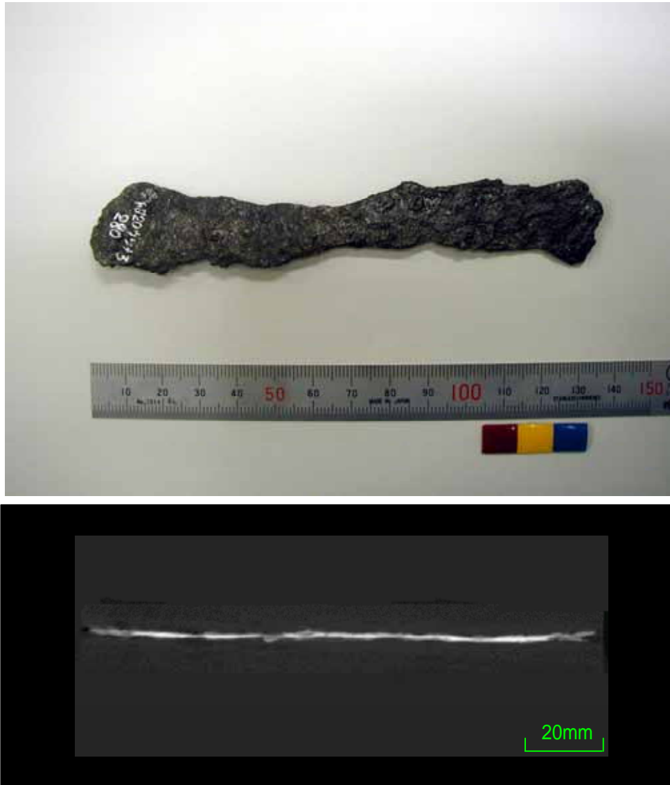
図 3-20 小形鉄鋳 (No.280) の外観とX線CT像
