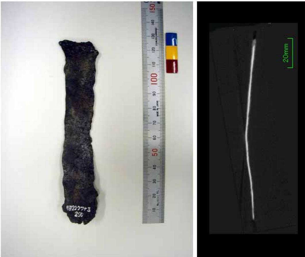
図 3-4 小形鉄鋌 (No.250) の外観とX線CT像
