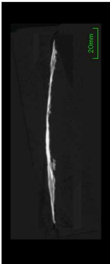
図 3-6 小形鉄錠 (No.253) の外観とX線CT像
