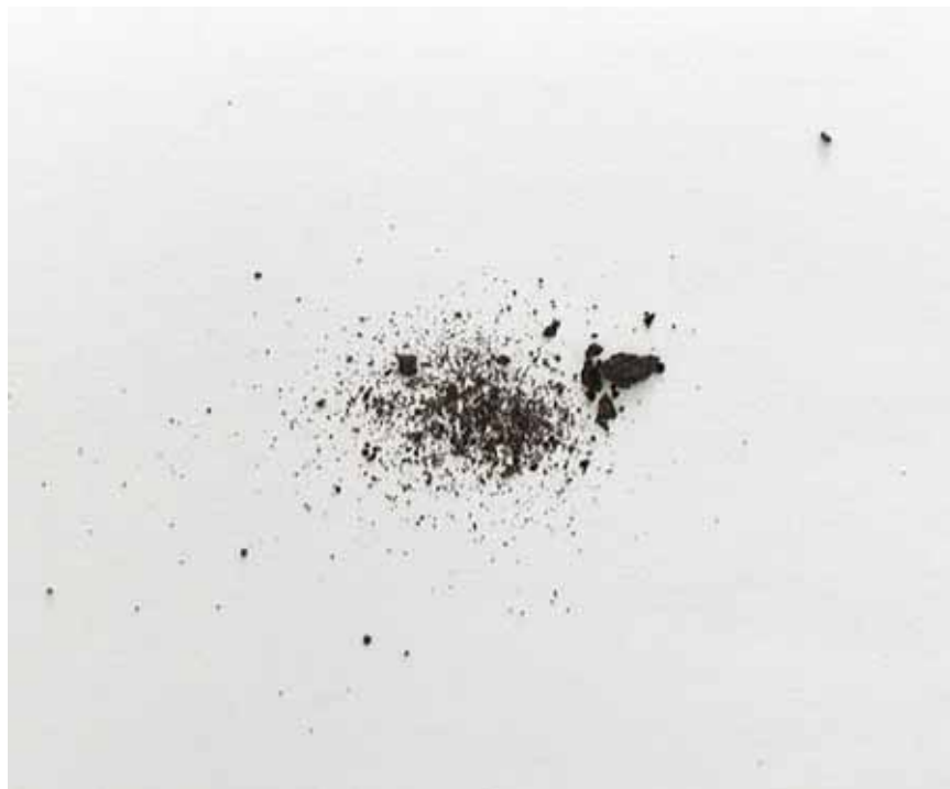
図 3-22 小形鉄釘表面錆層の外観
