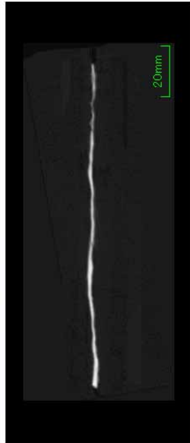
図 3-9 小形鉄錠 (No.258) の外観とX線CT像
