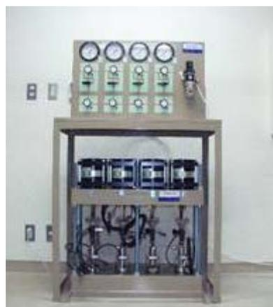
図 2.3.4.1-2 膨潤特性実験装置の概要
