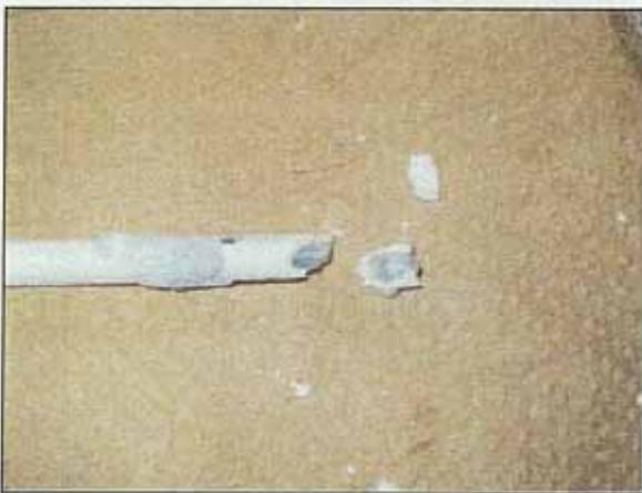
写真47 Run No.10通気配管閉塞状況1
