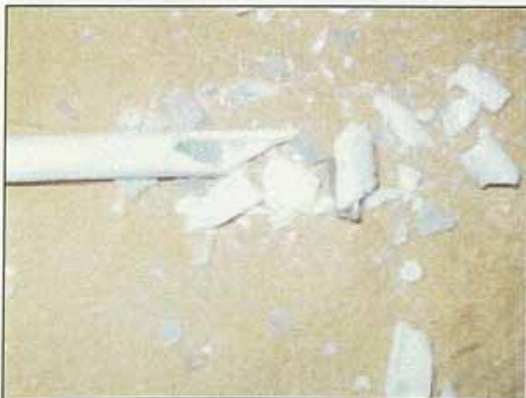
写真48 Run No.10通気配管閉塞状況2
