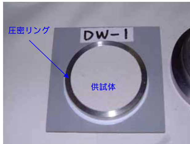
写真 1.4-8 圧縮成形後の供試体と圧密リング
