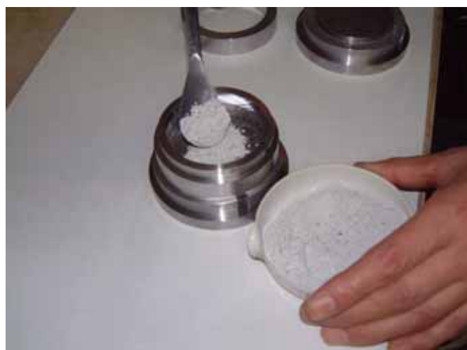
写真 1.4-2 圧密リングへの試料の投入
