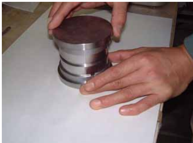
写真 1.4-4 上部载荷板の設置状況
