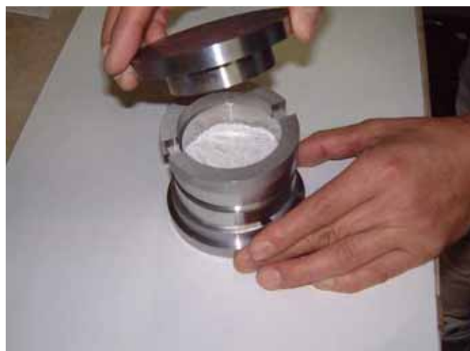
写真 1.4-3 試料投入後の上部載荷板の設置
