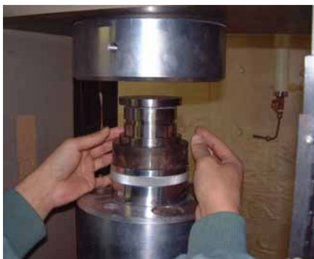
写真 1.4-6 圧縮試験機への設置
