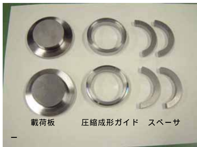
写真 1.4-1 圧密試料用圧縮成形治具
