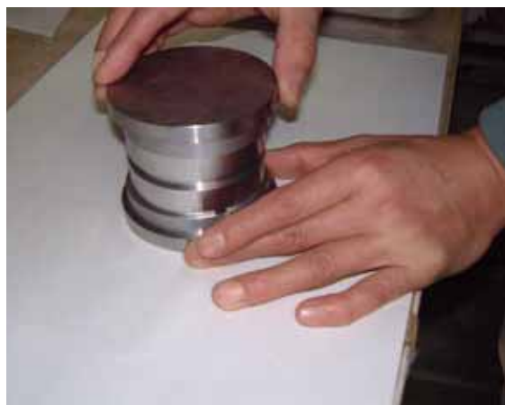
写真 1.4-2 上部載荷板の設置状況
