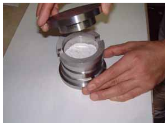
写真 1.4-3 試料投入後上部載荷板設置
