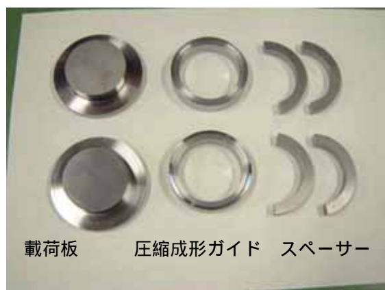
写真 1.4-1 圧密試料用圧縮成形治具
