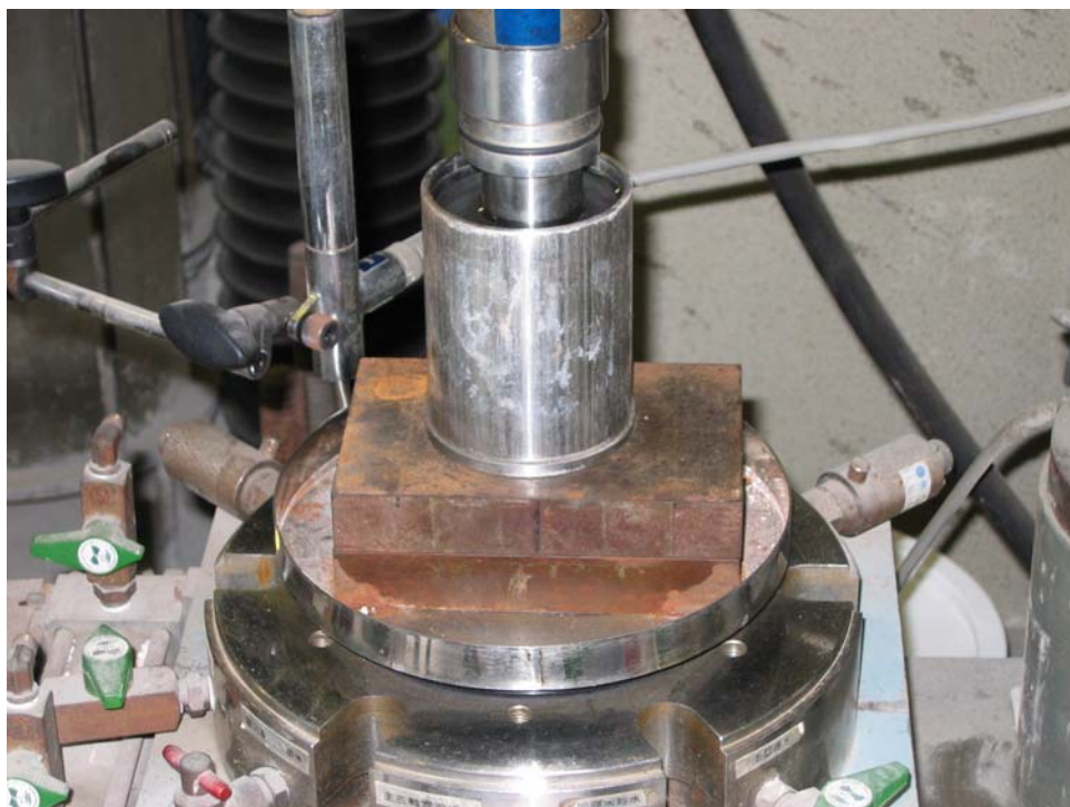
写真-3 一軸圧縮試験風景 20℃ ※ クリープ試験も同様の風景である
