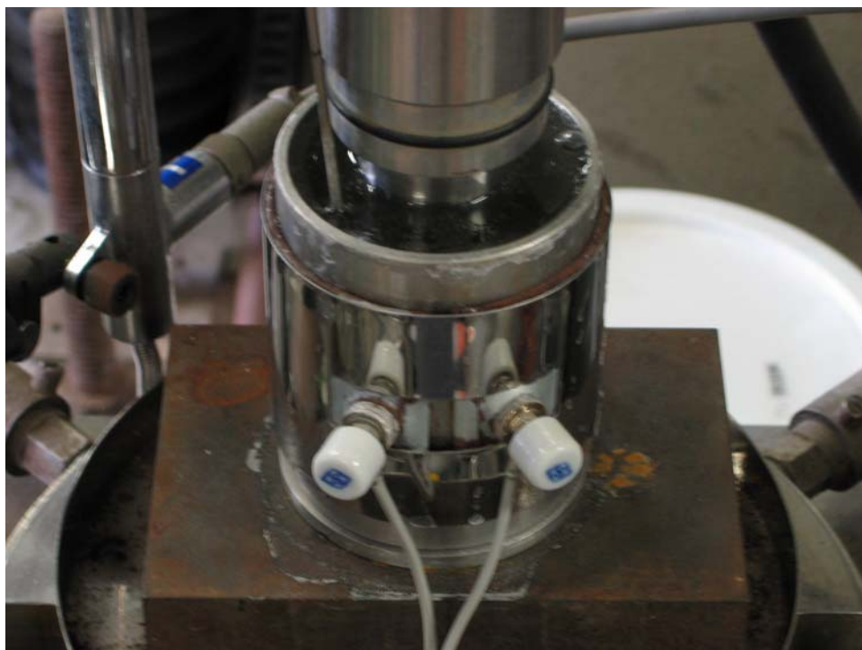
写真-4 一軸圧縮試験風景 80℃ ※クリープ試験も同様の風景である
