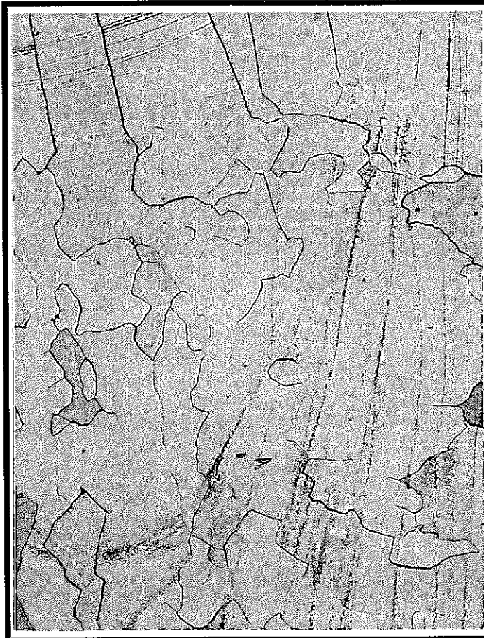
溶接熱影響部 - 母材境界
