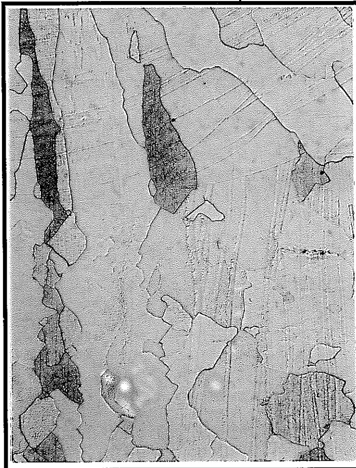
溶接熱影響部 - 母材境界
