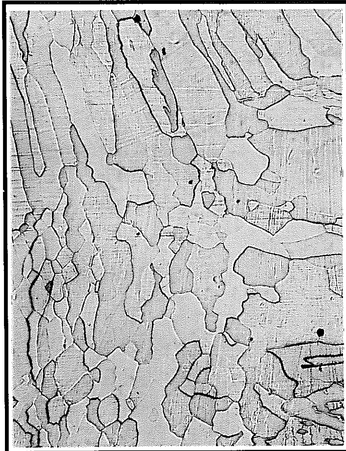
溶接熱影響部—母材境界
