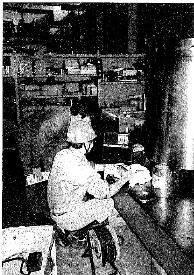
写真 3.3-2 対比試験片による確認作業
