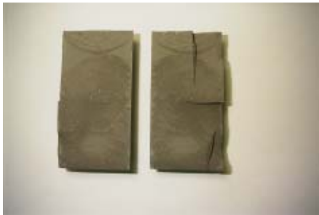
写真 5.13 OPC 硫化水銀 1%混合試験体の割裂面
