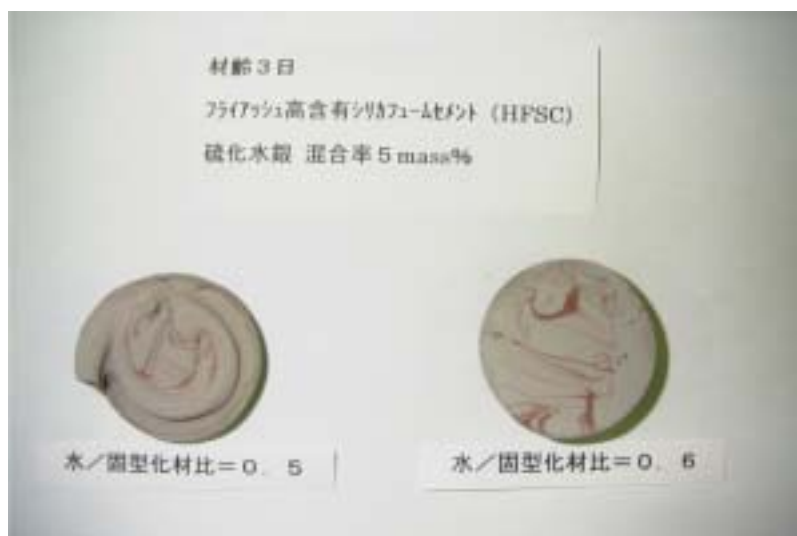
写真 24 フライッシュ高含有シリカフェーメント (HFSC) - 硫化水銀 混合率 5% 水準
