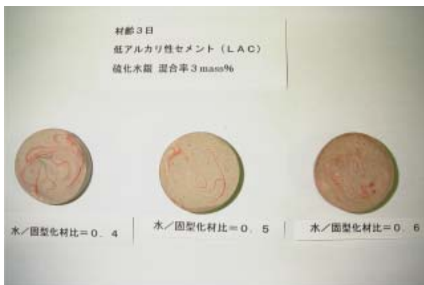
写真 19 低アルカリ性セメント (LAC) - 硫化水銀 混合率3%水準
