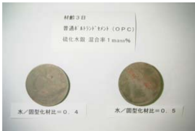
写真 10 普通ポルトランドセメント (OPC) - 硫化水銀 混合率 1 %水準
