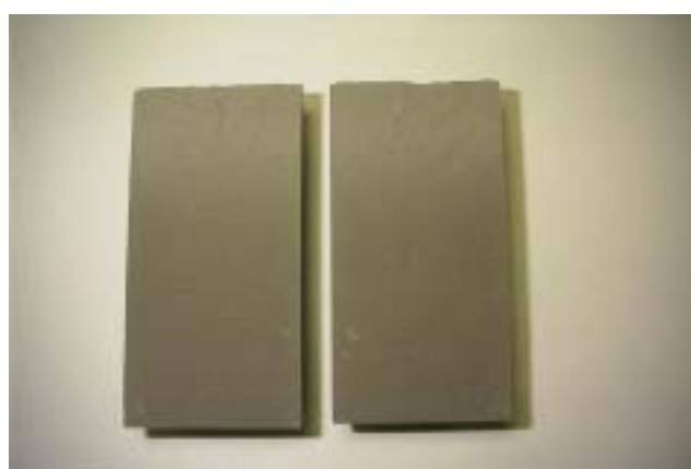
写真 5.26 HFSC 硫化水銀 3%混合試験体の割裂面
