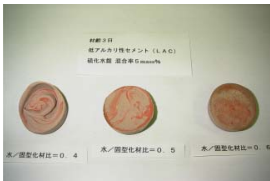
写真 20 低アルカリ性セメント ( L A C ) - 硫化水銀 混合率 5 % 水準
