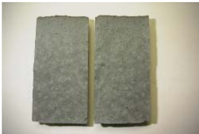
写真 5.7 HFSC 硫化鉛 20%混合試験体の割裂面
