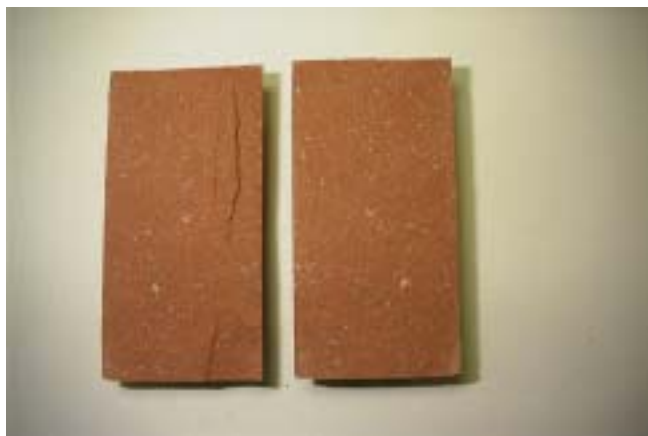
写真 5.24 LAC 硫化水銀 10%混合試験体の割裂面
