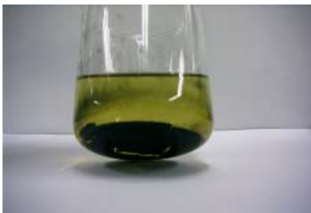
写真 11 硫黄 2.0 モル添加水準の沈殿洗浄ろ液 ( 黒色硫化水銀の生成が、認められる )
