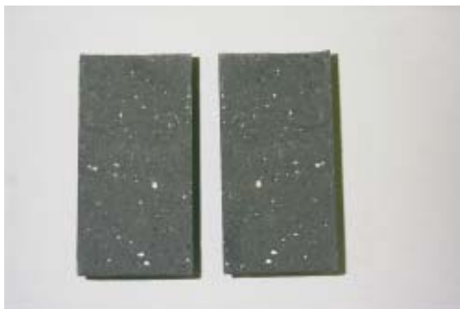
写真 5.10 LAC 硫化鉛 30% - 硫黄添加の試験体割裂面
