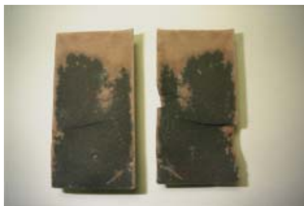
写真 5.19 BC 硫化水銀 3 % 混合試験体の割裂面
