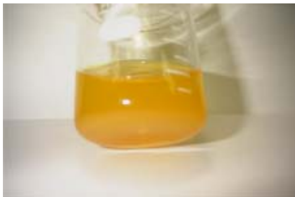
写真 24 NaOH4mass%の沈殿洗浄ろ液 ( 黒色硫化水銀の生成は認められない )
