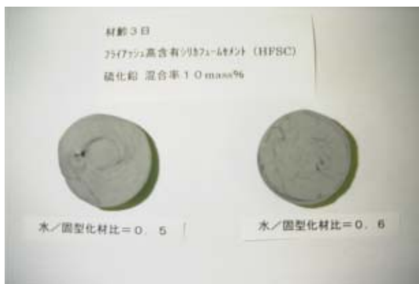
写真 6 フライッシュ高含有シリカセメント (HFSC) - 硫化鉛 混合率 10% 水準
