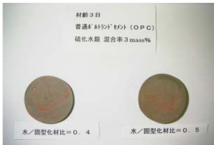
写真 11 普通ポルトランドセメント (OPC) - 硫化水銀 混合率 3 %水準
