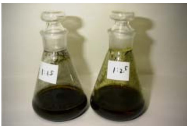
写真1 80 - 反応1時間後（左 1.5 ㍓，右 2.5 ㍓硫黄添加）
