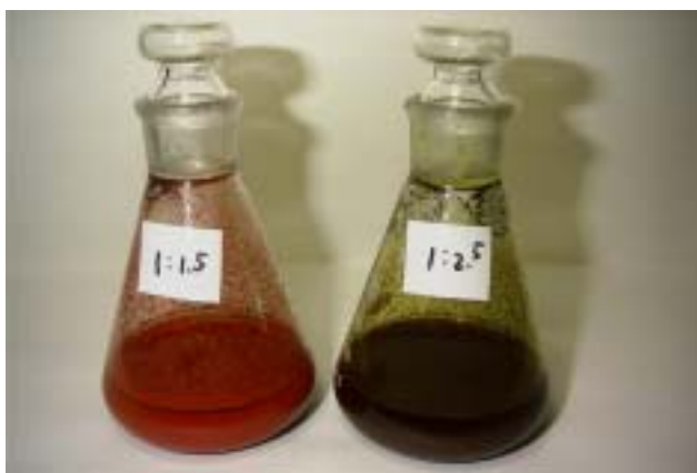
写真3 80 - 反応2時間後（左 1.5 ㍓，右 2.5 ㍓硫黄添加）
