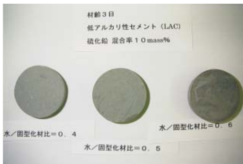
写真2 低アルカリ性セメント (LAC) - 硫化鉛混合率 10%水準
