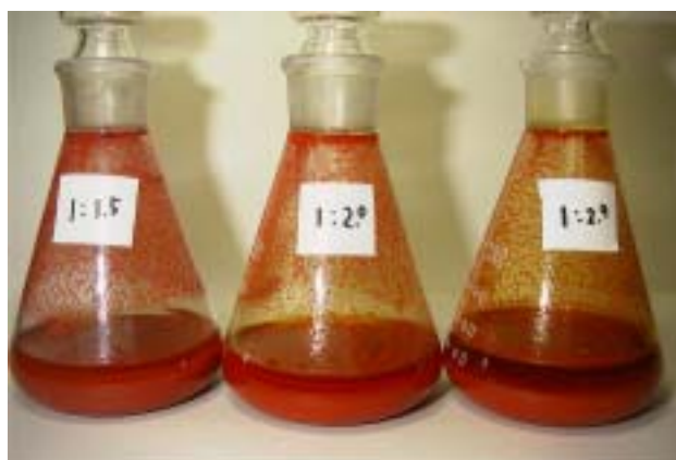
写真8 80 - 反応4時間30分後（左 1.5 ㄔ, 中央 2.0 ㄔ, 右 2.9 ㄔ硫黄添加）
