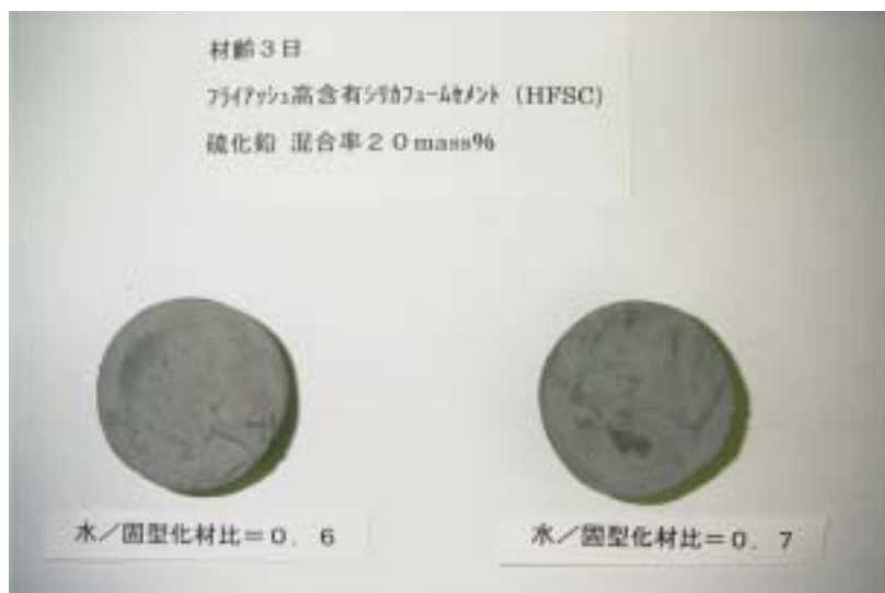
写真7 フライアッシュ高含有珪砂系セメント (HFSC) - 硫化鉛 混合率20%水準
