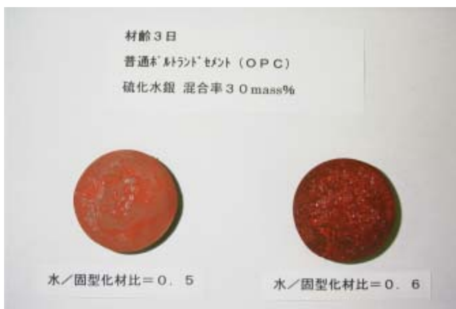
写真 13 普通ポルトランドセメント (OPC) - 硫化水銀 混合率 30% 水準
