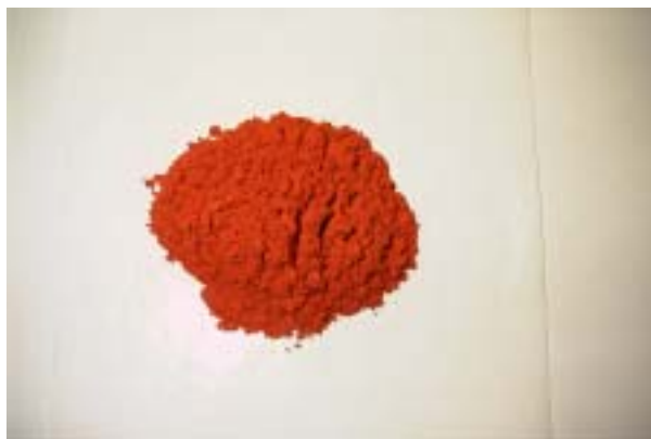
写真 16 回収した赤色硫化水銀（硫黄 2.5 モル添加） （金属水銀の残存は，認められない）
