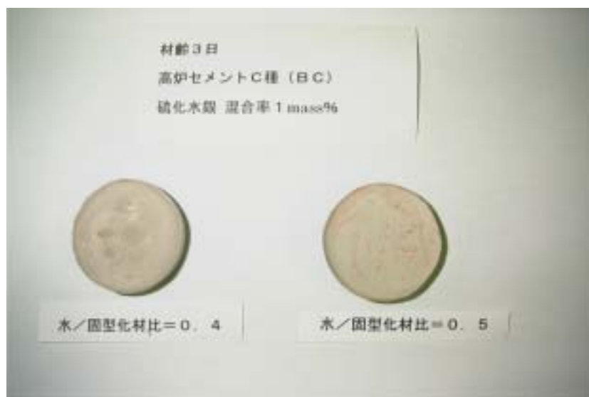
写真 15 高炉セメントC種 (BC) - 硫化水銀 混合率 1%水準
