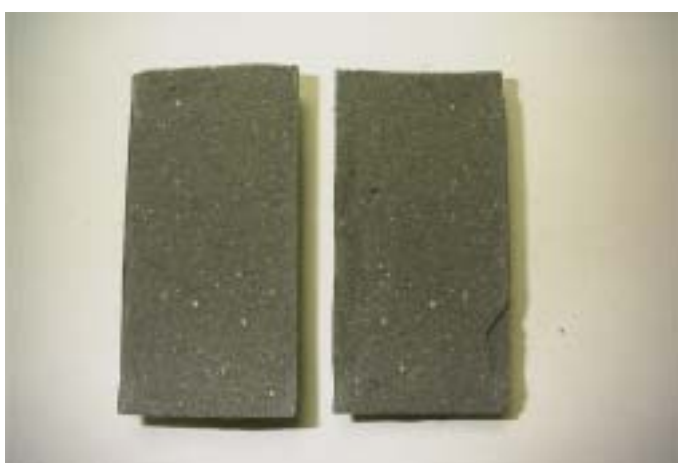
写真 5.3 LAC 硫化鉛 20%混合試験体の割裂面
