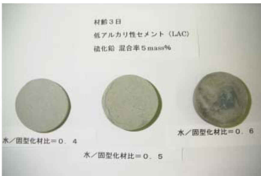
写真1 低アルカリ性セメント (LAC) - 硫化鉛混合率 5%水準
