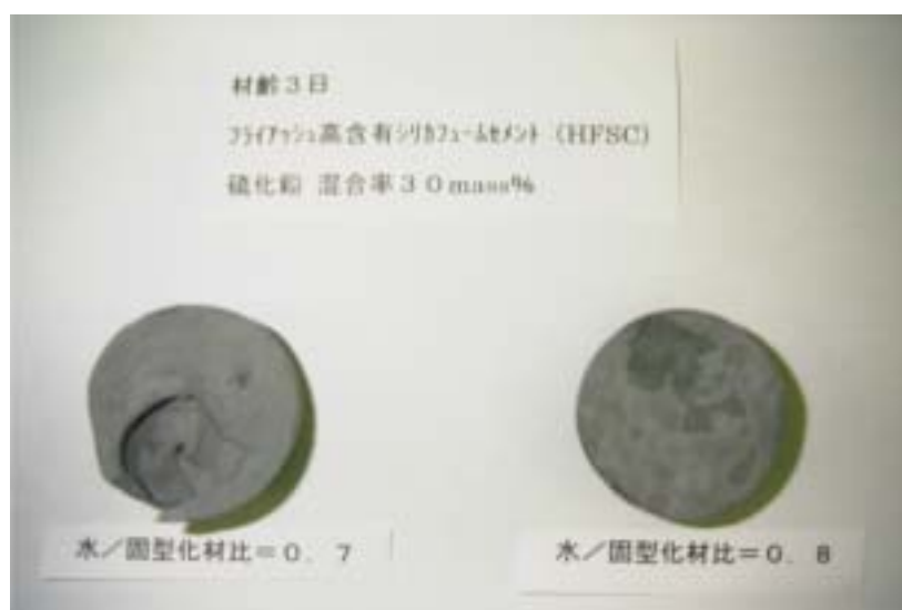
写真8 フライアッシュ高含有珪砂系セメント (HFSC) - 硫化鉛 混合率30%水準
