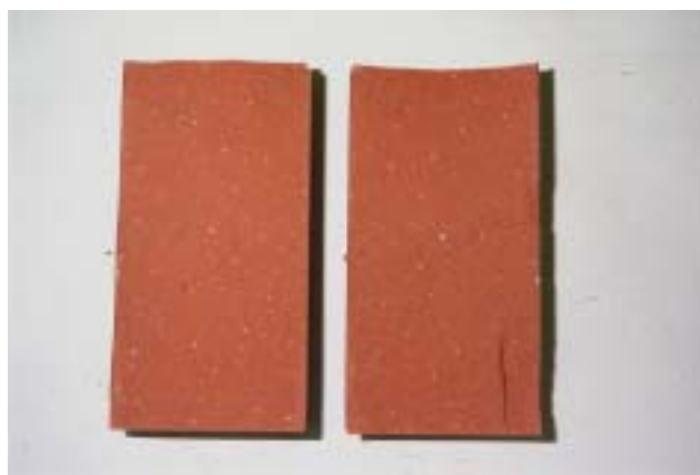
写真 5.25 LAC 硫化水銀 30%混合試験体の割裂面
