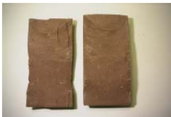
写真 5.15 OPC 硫化水銀 5%混合試験体の割裂面
