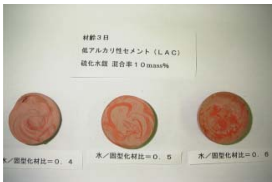
写真 21 低アルカリ性セメント ( L A C ) - 硫化水銀 混合率 10 % 水準
