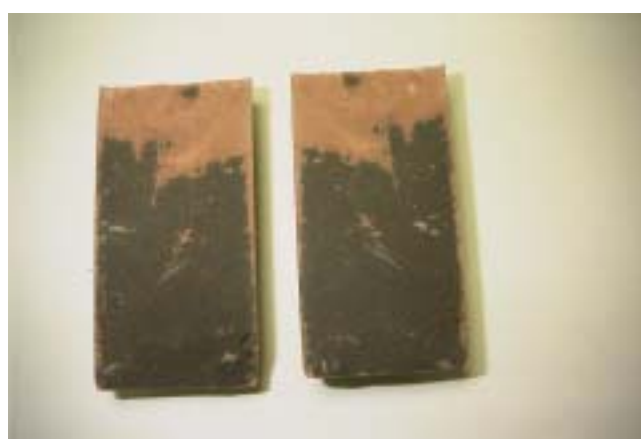
写真 5.20 BC 硫化水銀 5 % 混合試験体の割裂面
