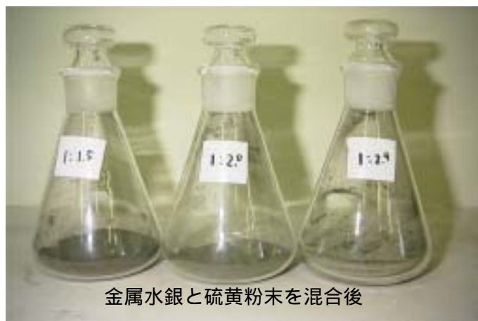
写真 4.3 硫化試験開始前の状況
