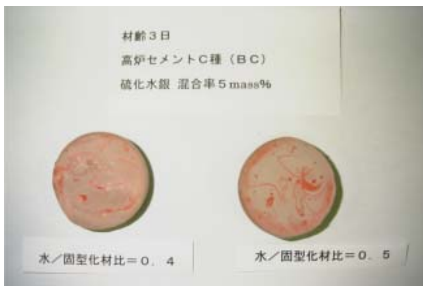
写真 17 高炉セメントC種 (BC) - 硫化水銀 混合率 5%水準
