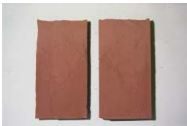
写真 5.29 HFSC 硫化水銀 30%混合試験体の割裂面
