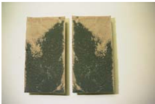
写真 5.18 BC 硫化水銀 1 % 混合試験体の割裂面
