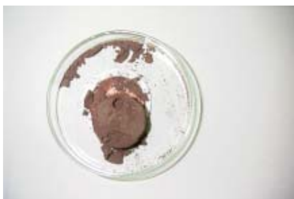
写真 26 回収した赤色硫化水銀 ( NaOH4mass% )
