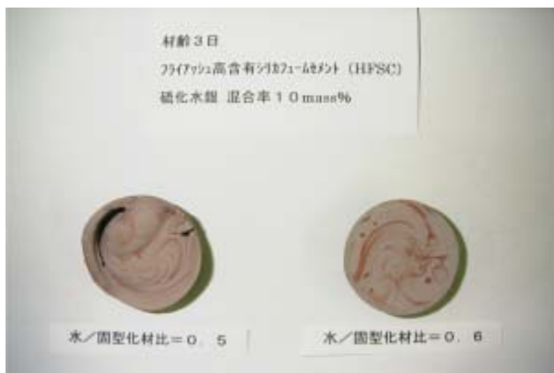
写真 25 フライッシュ高含有シリカフェーメント (HFSC) - 硫化水銀 混合率 10% 水準
