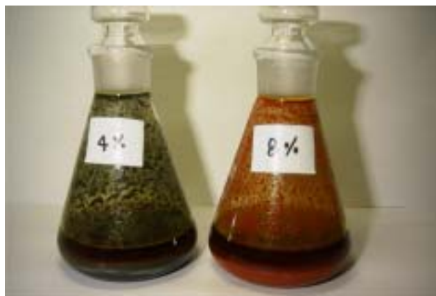
写真 19 80 - 反応 32 時間後 ( 左 NaOH4mass% , 右 8mass% )
