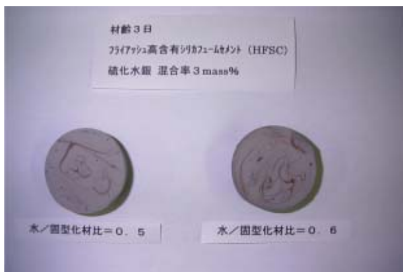
写真 23 フライッシュ高含有シリカセメント ( H F S C ) - 硫化水銀 混合率 3 %水準
