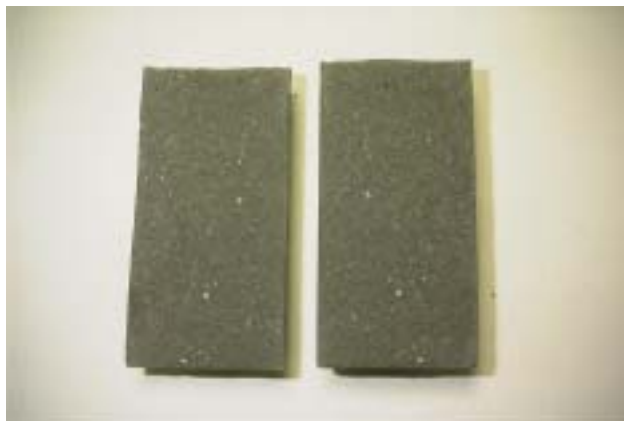
写真 5.4 LAC 硫化鉛 30%混合試験体の割裂面
