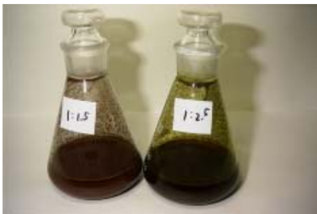
写真2 80 - 反応1時間50分後（左 1.5 ㍓，右 2.5 ㍓硫黄添加）
