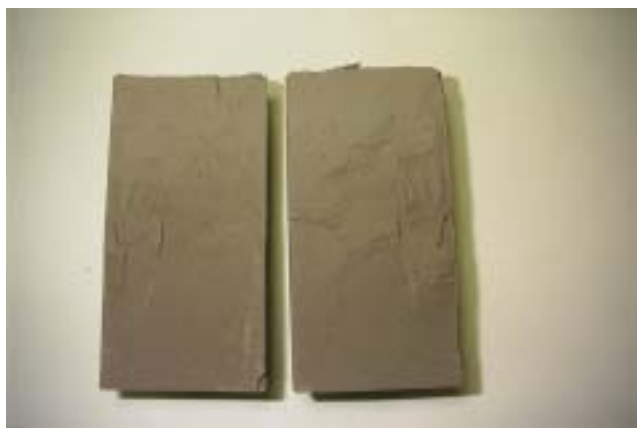
写真 5.27 HFSC 硫化水銀 5%混合試験体の割裂面
