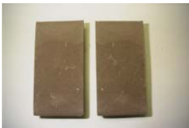
写真 5.14 OPC 硫化水銀 3%混合試験体の割裂面
