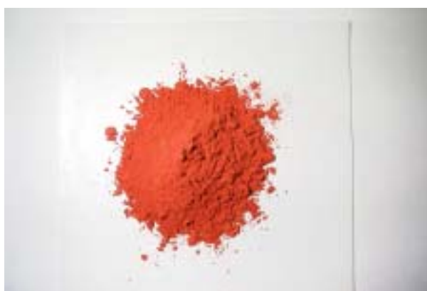
写真 17 回収した赤色硫化水銀（硫黄 2.9 モル添加） （金属水銀の残存は，認められない）
