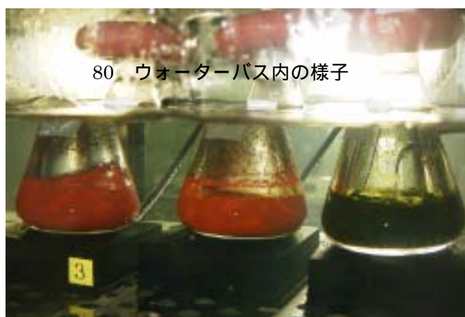
写真 4.4 硫化試験中の状況
