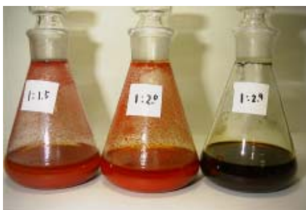
写真6 80 - 反応3時間後 (左 1.5 ㄍ, 中央 2.0 ㄍ, 右 2.9 ㄍ硫黄添加)
