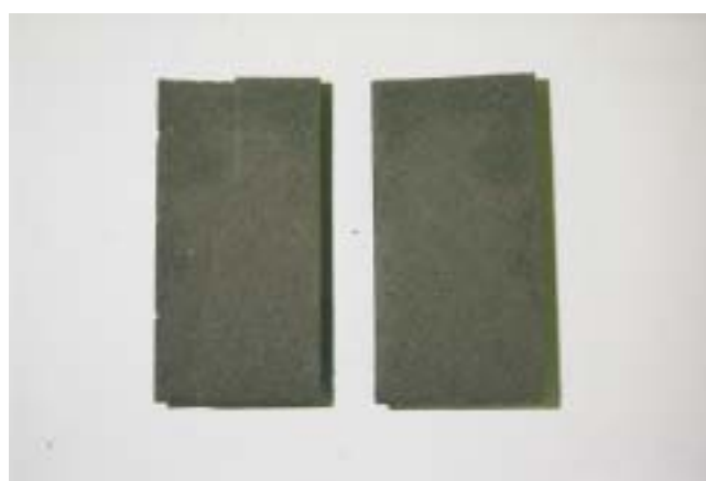
写真 5.12 LAC 硫化鉛 30% - 塩化鉄( )添加の試験体割裂面
