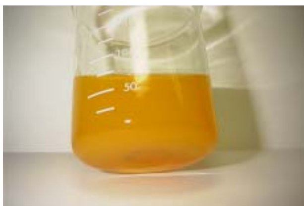
写真 23 NaOH8mass%の沈殿洗浄ろ液 (黒色硫化水銀の生成は認められない)
