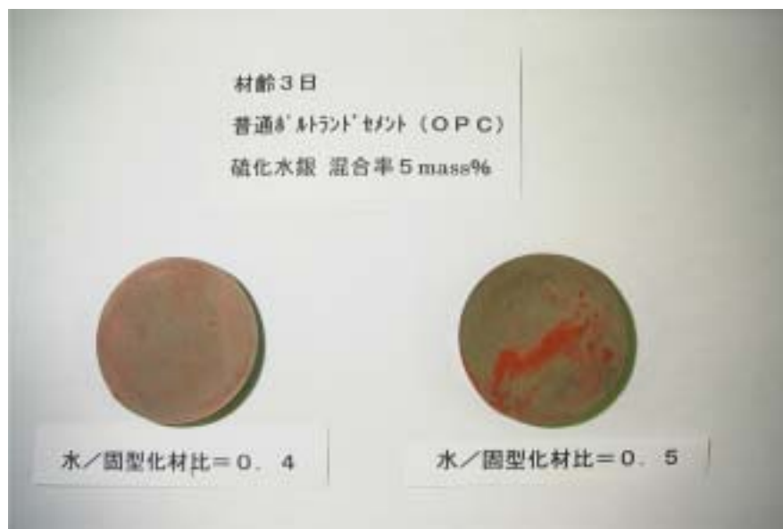
写真 12 普通ポルトランドセメント (OPC) - 硫化水銀 混合率 5% 水準
