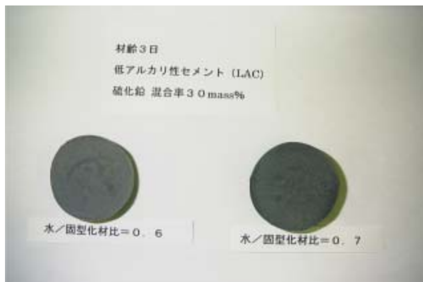
写真4 低アルカリ性セメント ( L A C ) - 硫化鉛混合率 30%水準
