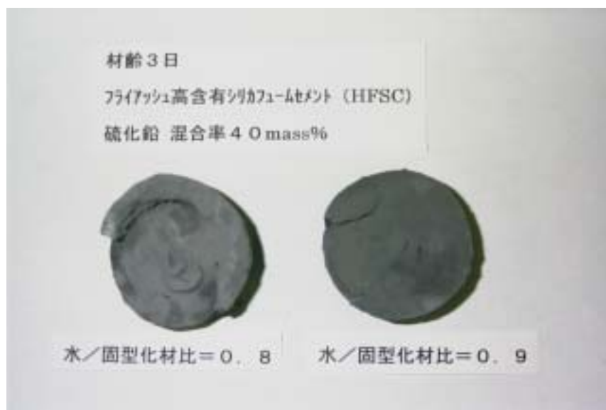
写真9 フライアッシュ高含有シリカセメント (HFSC) - 硫化鉛 混合率 40%水準
