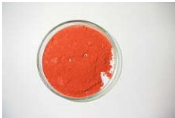
写真 25 回収した赤色硫化水銀 ( NaOH8mass% )
