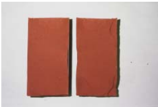
写真 5.16 OPC 硫化水銀 30%混合試験体の割裂面
