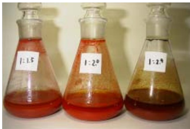
写真7 80 - 反応4時間後（左 1.5 ㄔ, 中央 2.0 ㄔ, 右 2.9 ㄔ硫黄添加）
