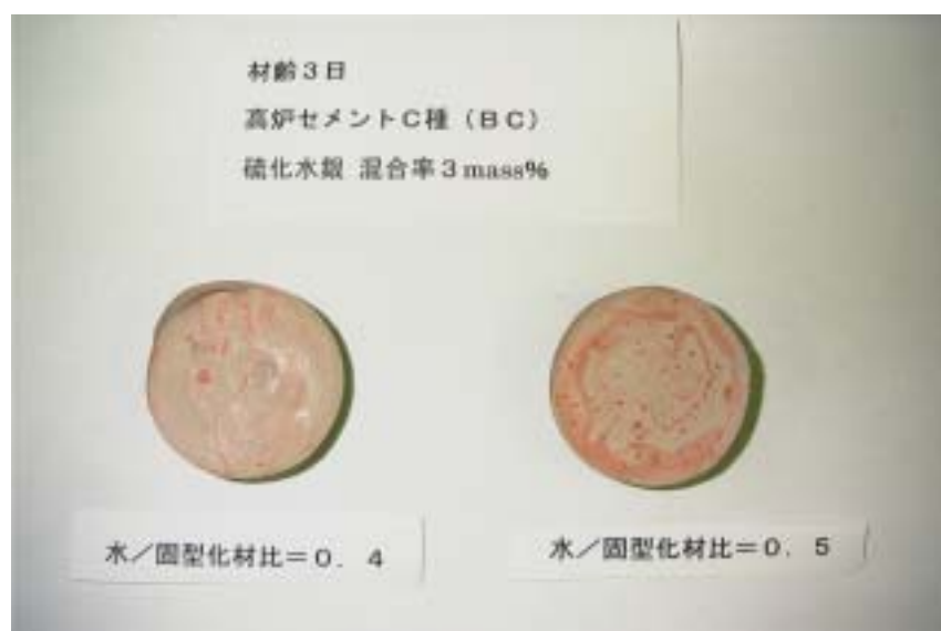
写真 16 高炉セメントC種 (BC) - 硫化水銀 混合率 3%水準
