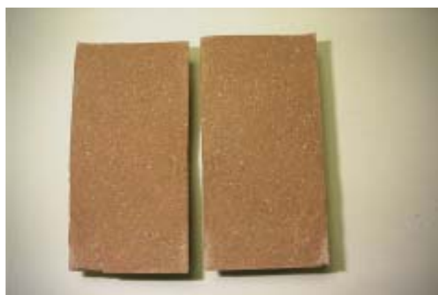
写真 5.23 LAC 硫化水銀 5%混合試験体の割裂面
