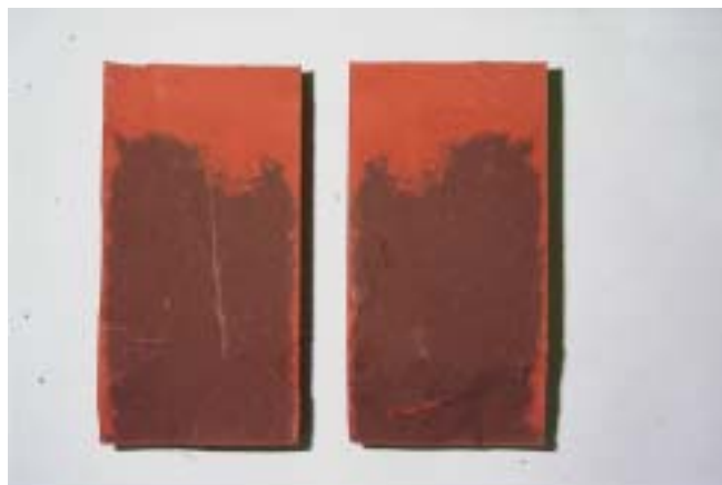
写真 5.21 BC 硫化水銀 30%混合試験体の割裂面
