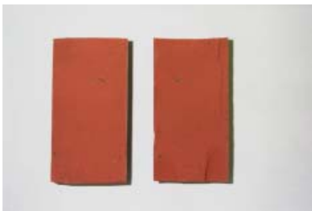
写真 5.17 OPC 硫化水銀 40%混合試験体の割裂面
