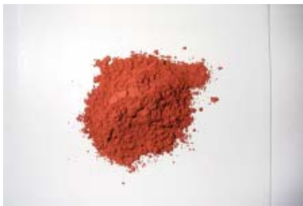
写真 14 回収した赤色硫化水銀 (硫黄 1.5 モル添加) (金属水銀の残存は、認められない)
