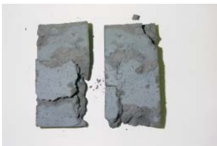
写真 5.9 HFSC 硫化鉛 40%混合試験体の割裂面
