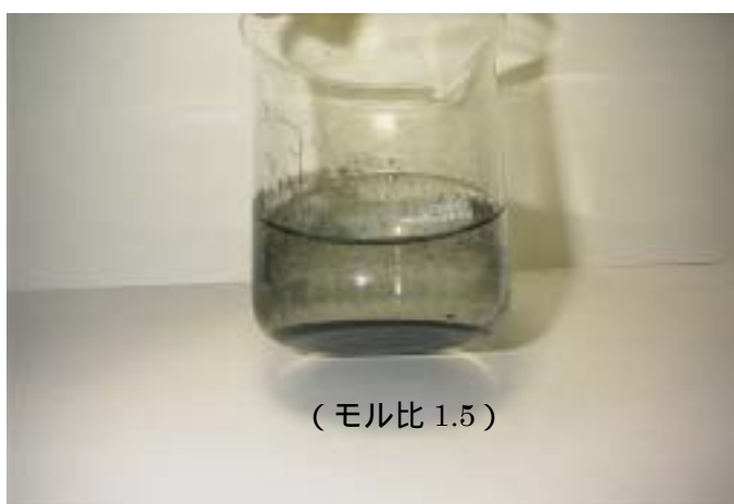
写真 4.7 赤色沈殿の洗浄水中に再析出した黑色硫化水銀
