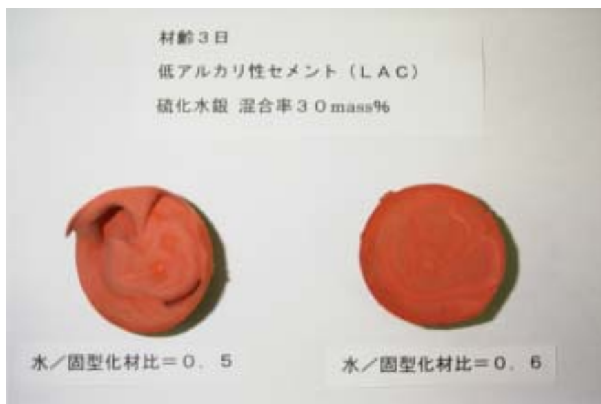
写真 22 低アルカリ性セメント ( L A C ) - 硫化水銀 混合率 30%水準
