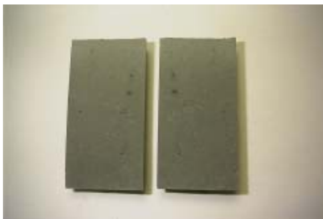
写真 5.5 HFSC 硫化鉛 5%混合試験体の割裂面
