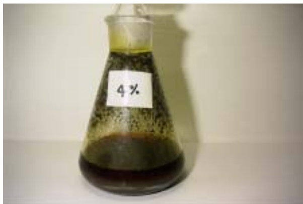
写真 21 80 - 反応 72 時間 試験中止後 (NaOH4mass%)
