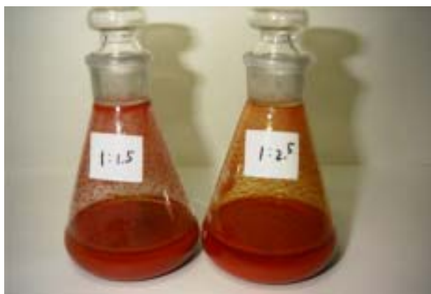
写真5 80 - 反応3時間後 (左 1.5 ㄍ, 右 2.5 ㄍ硫黄添加)
