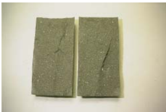
写真 5.2 LAC 硫化鉛 10%混合試験体の割裂面
