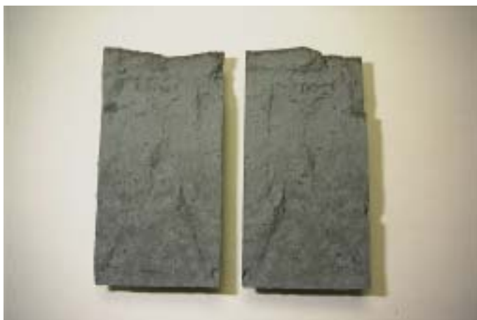
写真 5.8 HFSC 硫化鉛 30%混合試験体の割裂面
