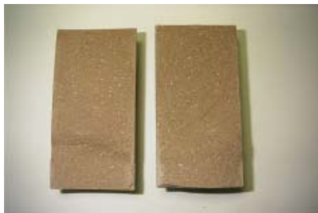
写真 5.22 LAC 硫化水銀 3%混合試験体の割裂面
