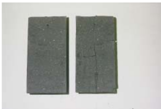
写真 5.11 LAC 硫化鉛 30% - 還元鉄添加の試験体割裂面
