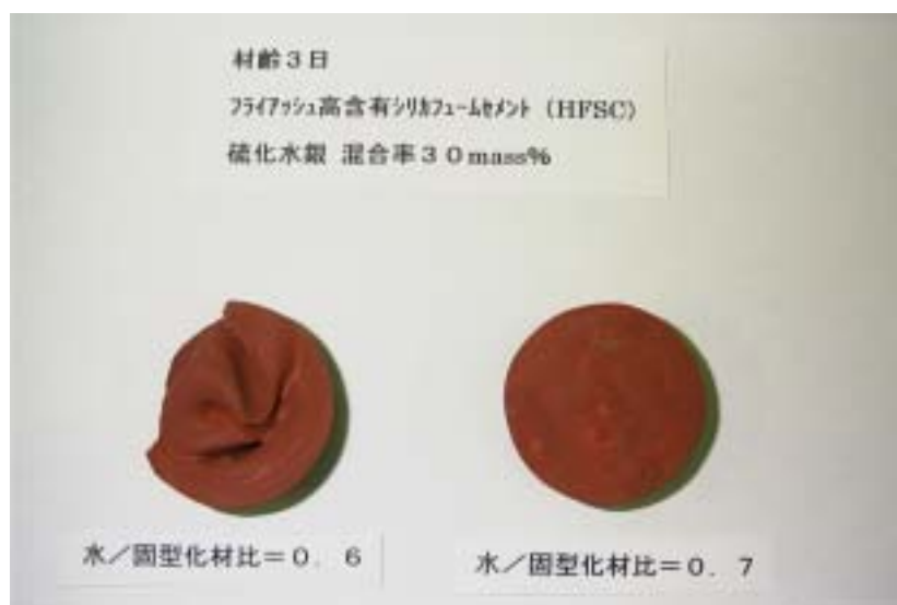
写真 26 フライッシュ高含有シリカセメント (HFSC) - 硫化水銀 混合率 30%水準
