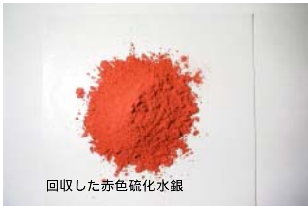
写真 4.8 硫化試験終了後の状況（硫黄添加モル比 2.9）
