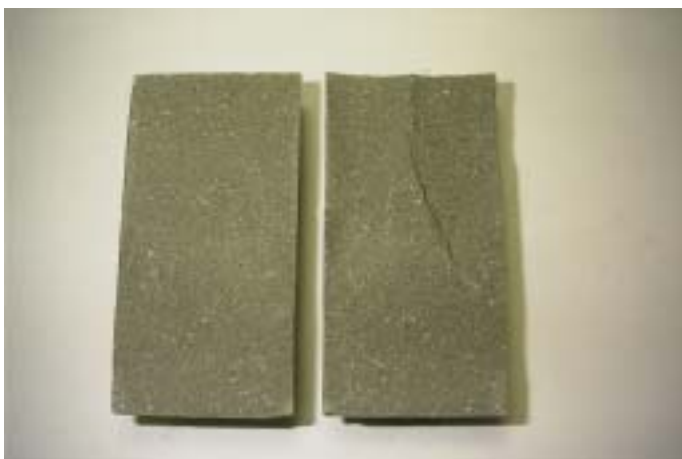
写真 5.1 LAC 硫化鉛 5%混合試験体の割裂面
