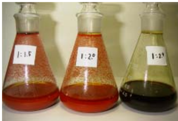
写真4 80 - 反応2時間後 (左 1.5 ㄍ, 中央 2.0 ㄍ, 右 2.9 ㄍ硫黄添加)
