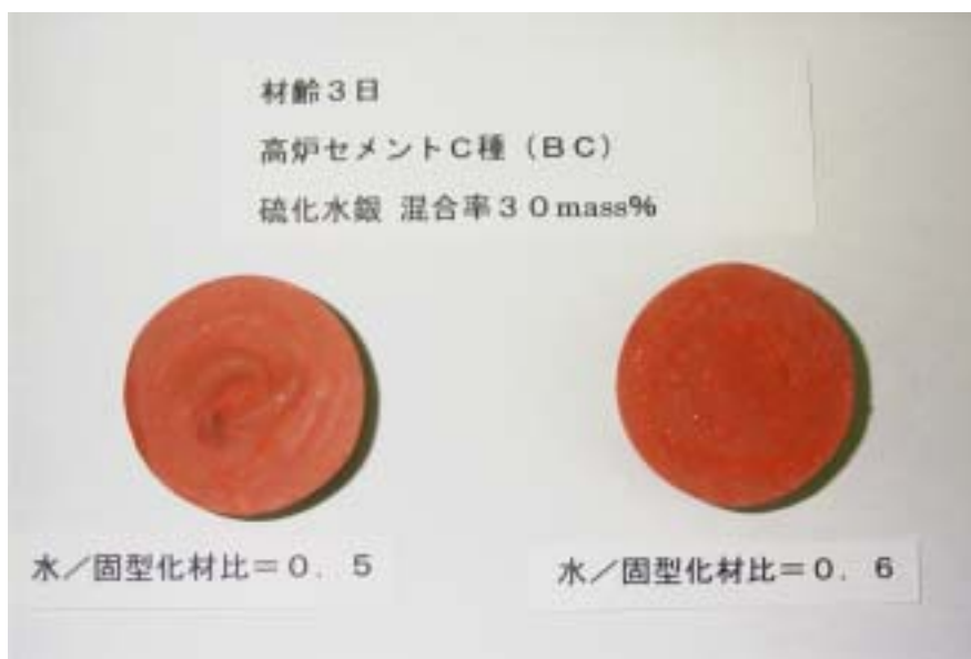
写真 18 高炉セメントC種 (BC) - 硫化水銀 混合率30%水準
