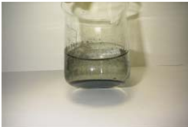
写真 10 硫黄 1.5 モル添加水準の沈殿洗浄ろ液 ( 黒色硫化水銀の生成が、認められる )
