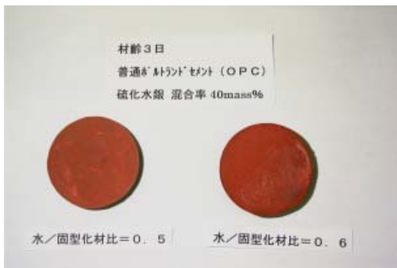
写真 14 普通ポルトランドセメント (OPC) - 硫化水銀 混合率 40%水準
