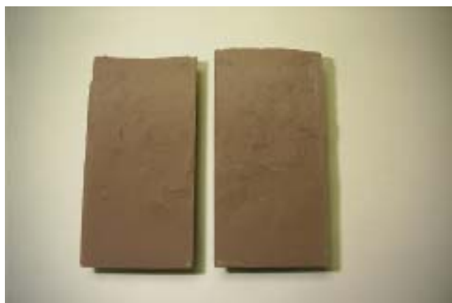
写真 5.28 HFSC 硫化水銀 10%混合試験体の割裂面
