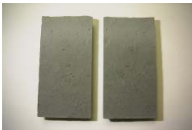
写真 5.6 HFSC 硫化鉛 10%混合試験体の割裂面
