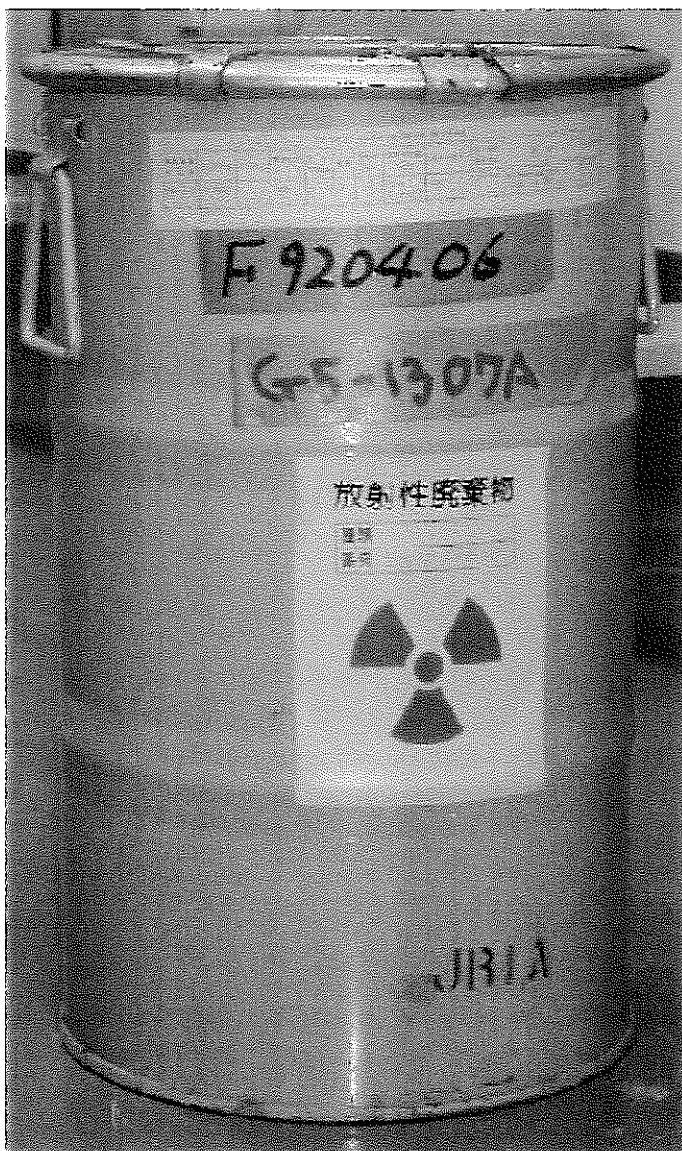
図1.2.2-10 塩廃棄物の保管容器（ドラム缶）の外観
