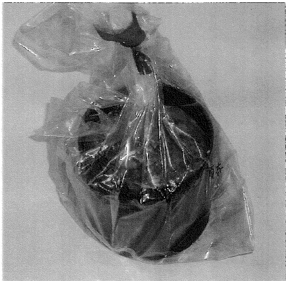
図1.2.2-12 保管容器から取出した塩廃棄物の外観
