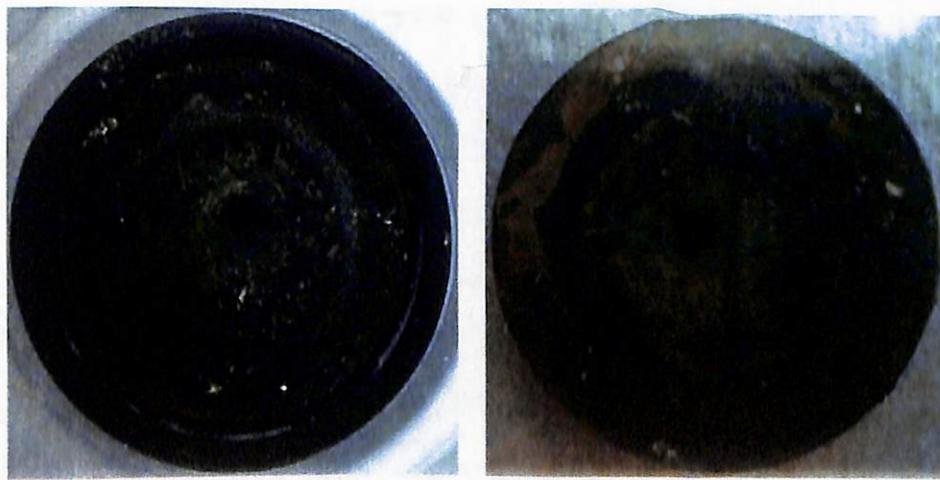
図 1.1-4 鉄片の写真（左：解体直後、右：解体後 1 時間、さびが赤さびに変化しつつある。）
