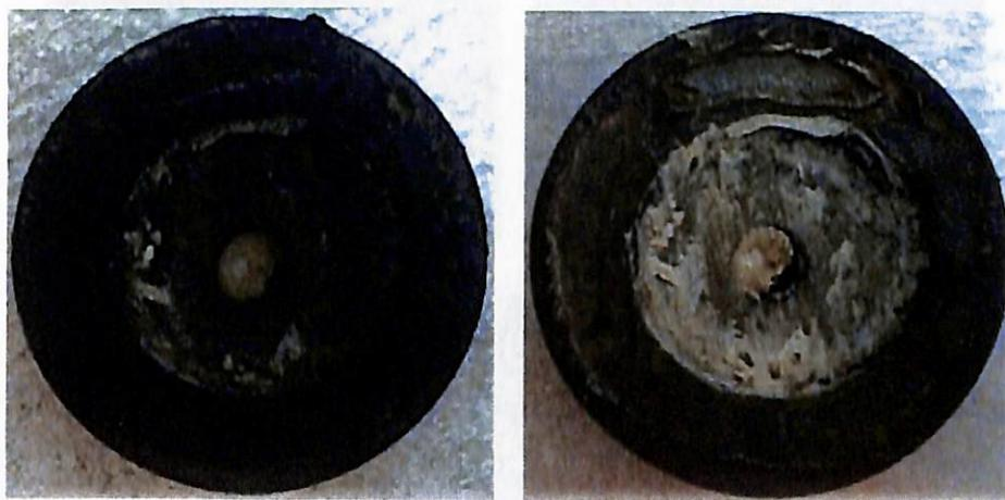
図 1.1-3 鉄片の写真（左：解体直後、右：解体後 1 時間、さびが赤さびに変化しつつある。）
