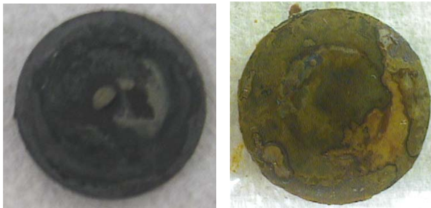
図 3.2-3 鉄片の写真（左：解体直後、右：解体後 1 時間、さびが赤さびに変化しつつある。）クニゲル V 1（ 1.6\text{Mg/m}^3 ）と 154 週間接触
