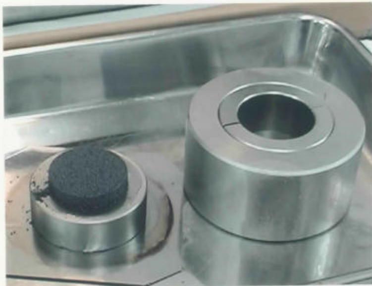
写真 3.2-2 ダイス取外し後の粒子焼結体外観
