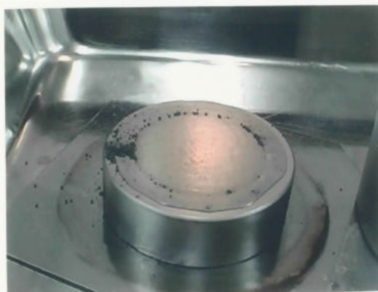
写真 3.2-4 粒子焼結体からの脱落粒子外観
