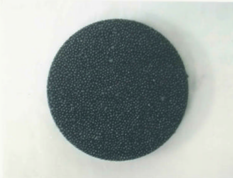
写真 3.3-11 熱伝導度測定試験後の粒子焼結体上面
