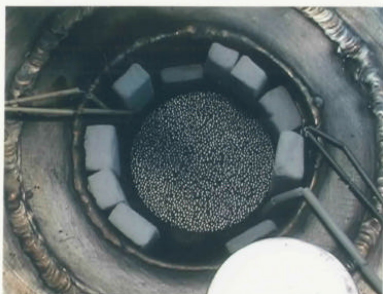
写真 3.3-2 熱伝導度測定試験前の粒子焼結体外観
