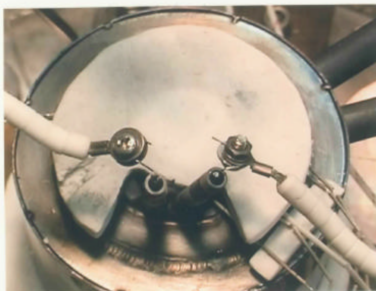
写真 3.3-5 熱伝導度測定試験前の上部断熱材外観
