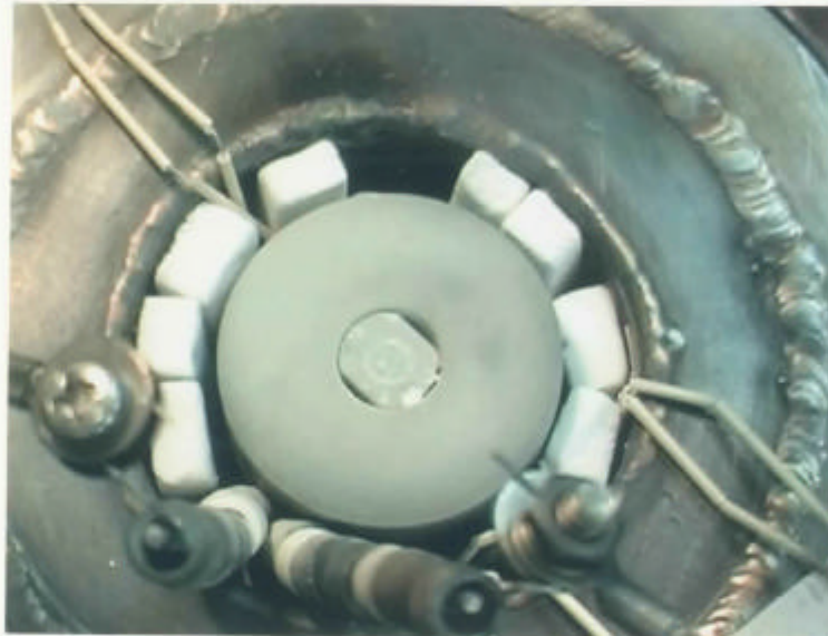
写真 3.3-7 熱伝導度測定試験後の上部加熱ヒーター外観
