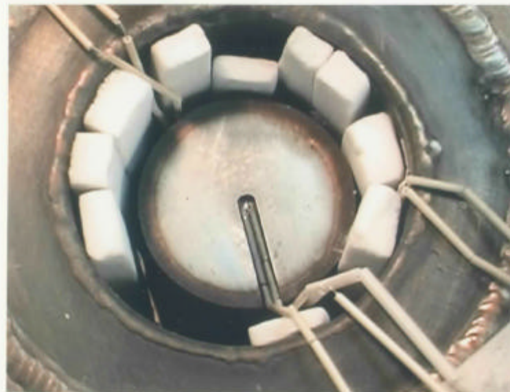
写真 3.3-8 熱伝導度測定試験後の上部均熱板外観
