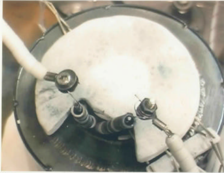
写真 3.3-6 熱伝導度測定試験後の上部断熱材外観
