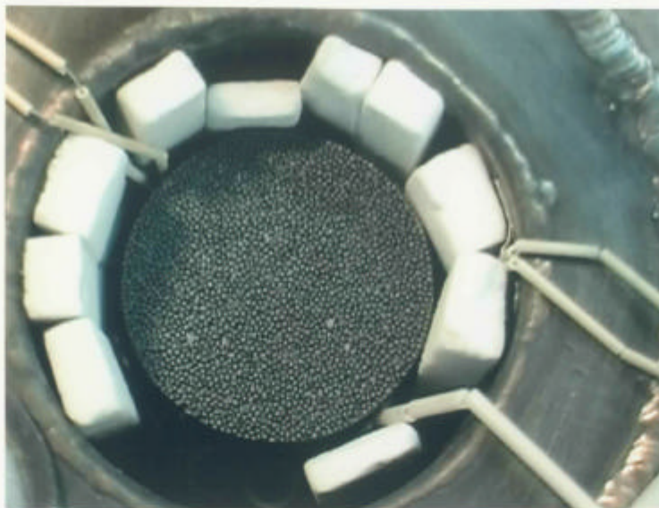
写真 3.3-9 熱伝導度測定試験後の粒子焼結体外観
