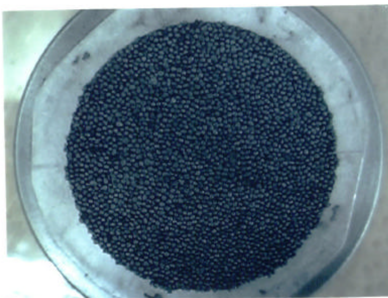
写真 3.2-4 製作試験後の粒子焼結体①の外観 (4)
