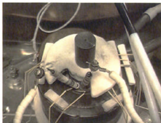
⑧ 上部断熱材装荷
