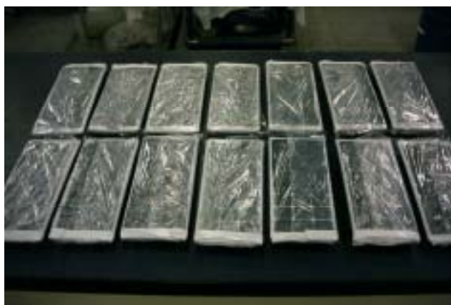
写真 3.6 20 養生中の固化体(外観)
