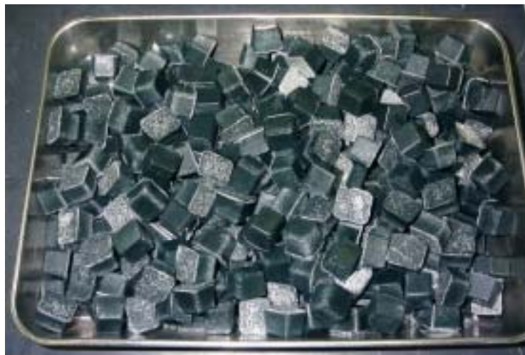
写真 3.7 脱型直後の固化体(4週間後)
