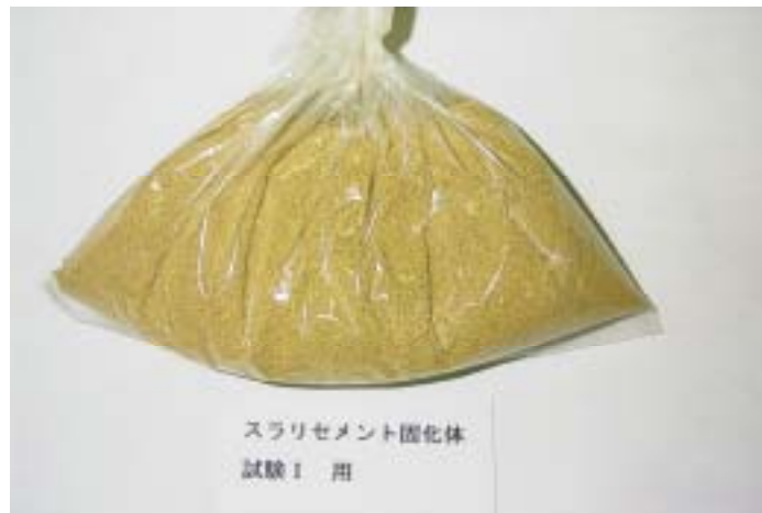
写真 3.15 固化体の粉末(粉砕調製後：粒径 0.5 ~ 1.18mm)
