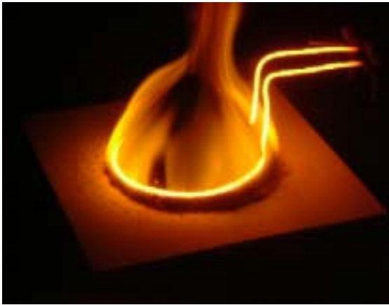
写真 3.4. 燃焼試験の燃焼状況（硝酸塩廃液セメント固化体 1:1）
