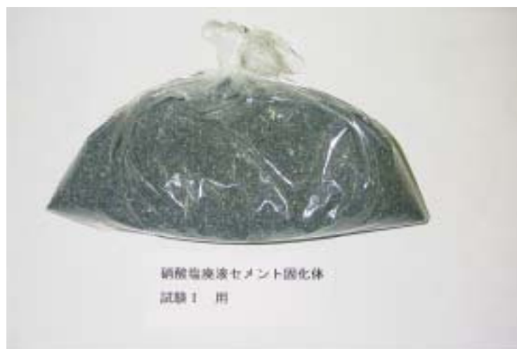
写真 3.8 固化体の粉末(粉砕調製後：粒径 0.5～1.18mm)
