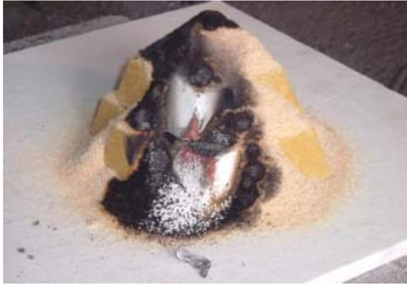
写真 4.大量燃焼試験 燃焼状況（スラリーセメント固化体）
