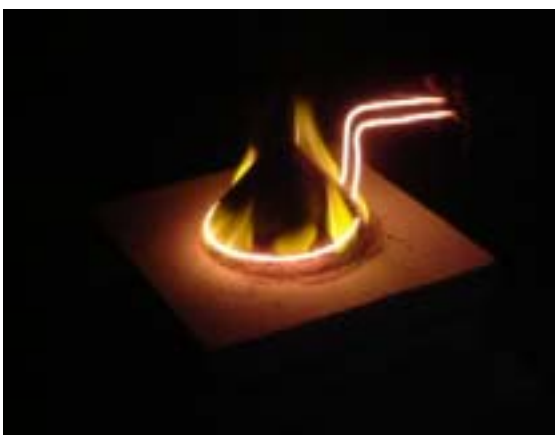
写真 7.8. 燃焼試験の燃焼状況（スラリーセメント固化体 1:1）
