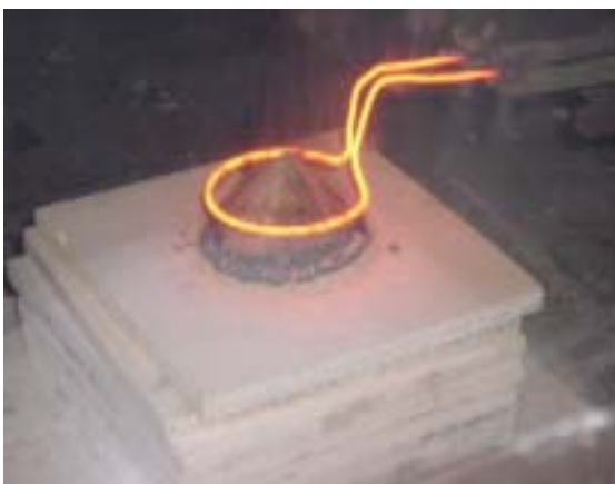
写真 13.14. 燃焼試験の燃焼状況（高濃度アルカリ廃液セメント固化体 4:1）
