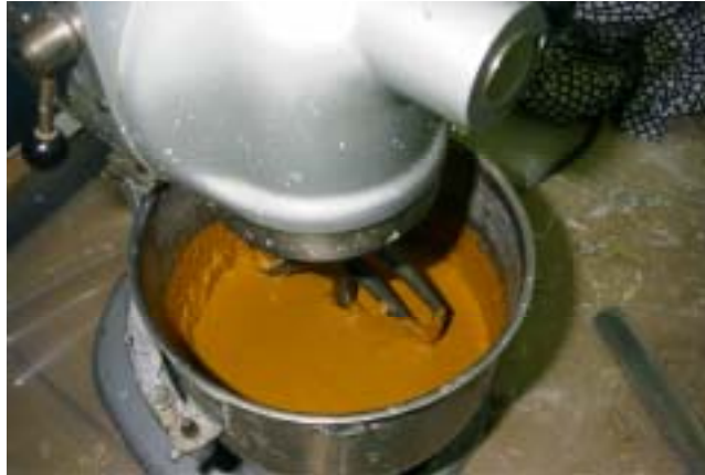
写真 3.9 混練前の廃液（廃液温度 80 にて混練）
