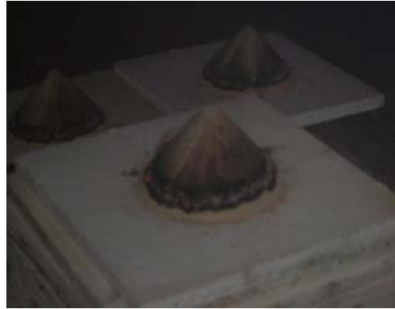
写真 9.10. 燃焼試験の燃焼状況（スラリセメント固化体 4:1）
