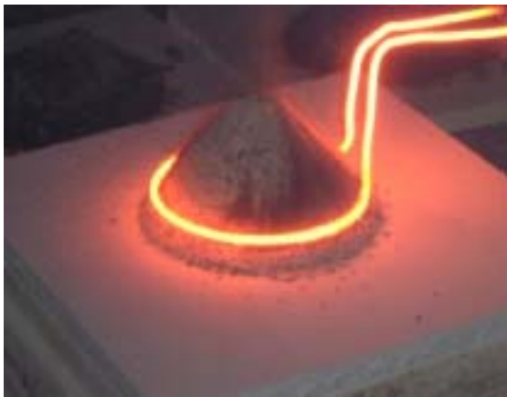
写真 5.6. 燃焼試験の燃焼状況（硝酸塩廃液セメント固化体 4:1）
