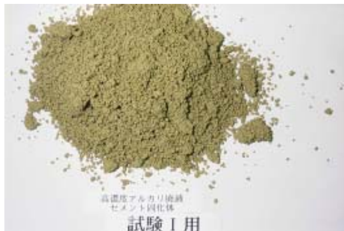
写真 3.23 固化体の粉末(粉砕調製後：粒径 0.5 ~ 1.18mm)
