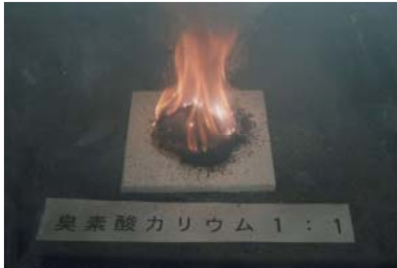
写真 1. 燃焼試験の燃焼状況 (標準物質: 臭素酸カリウム 1:1)
