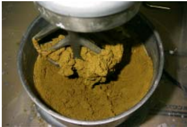
写真 5-1 常温で混練した時の状況
