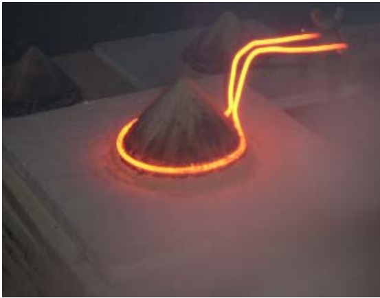
写真 9.10. 燃焼試験の燃焼状況（スラリセメント固化体 4:1）
