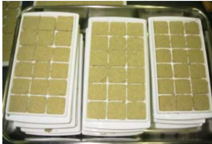
写真 3.22 脱型直後の固化体(4週間後)
