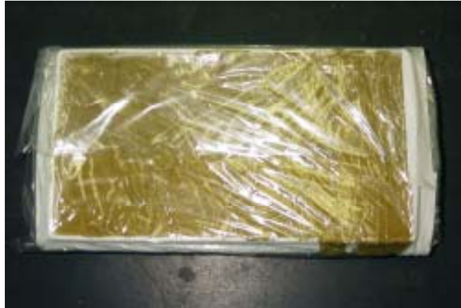
写真 3.12 密閉封緘後の固化体
