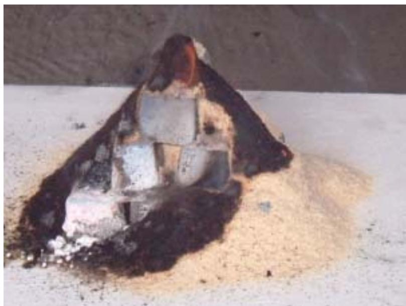
写真 3.大量燃焼試験 燃焼状況（硝酸塩廃液セメント固化体）
