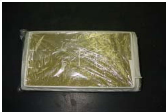
写真 3.20 密閉封緘後の固化体
