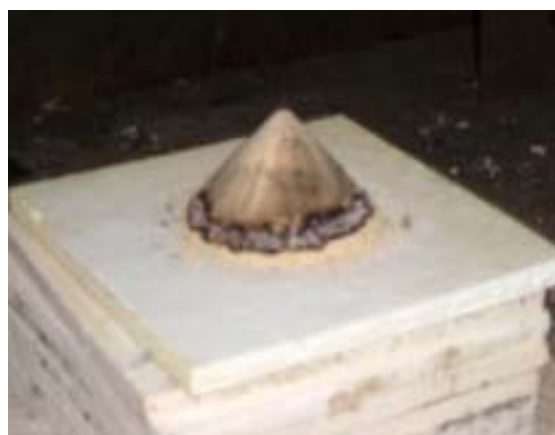
写真 13.14. 燃焼試験の燃焼状況（高濃度アルカリ廃液セメント固化体 4:1）
