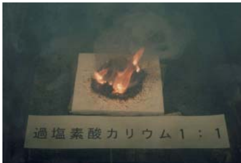
写真 2. 燃焼試験の燃焼状況 (標準物質: 過塩素酸カリウム 1:1)
