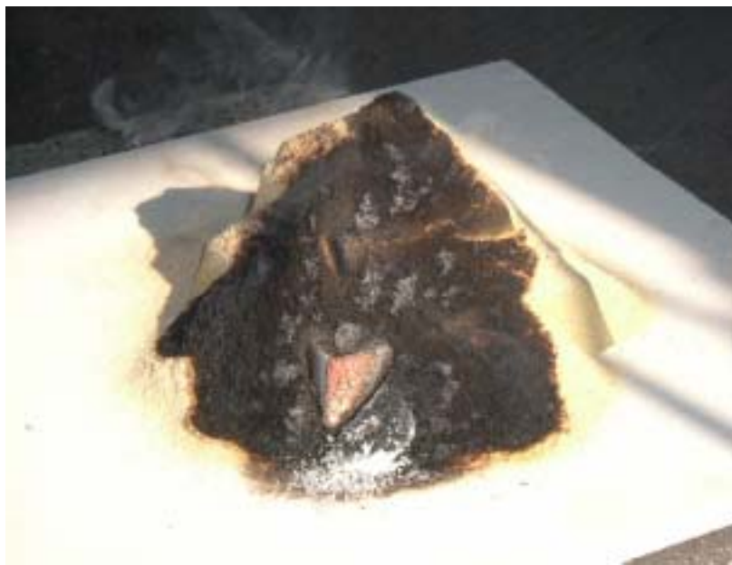
写真 5.大量燃焼試験 燃焼状況（高濃度アルカリ廃液セメント固化体）
