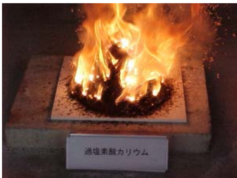
写真 1.大量燃焼試験 燃焼状況（過塩素酸カリウム）
