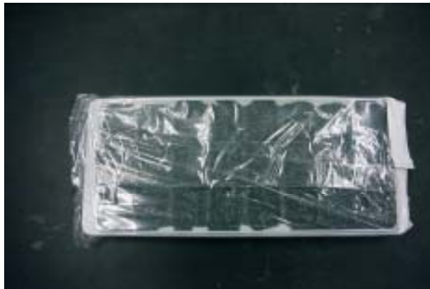
写真 3.5 密閉封緘後の固化体
