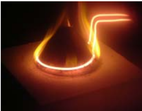
写真 11.12. 燃焼試験の燃焼状況（高濃度アルカリ廃液セメント固化体 1:1）
