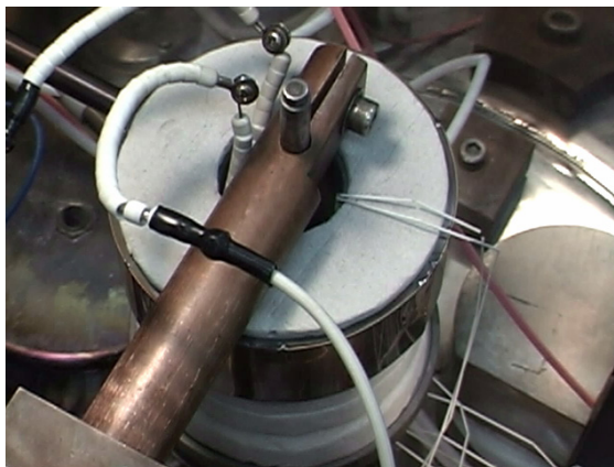
⑦上部W冷却棒及び水冷電極接続
