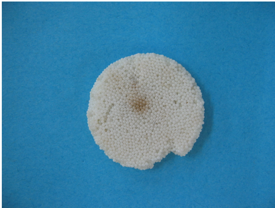
写真 3.3-6 熱伝導度測定試験後の粒子焼結体（ネック比 20%）の外観
