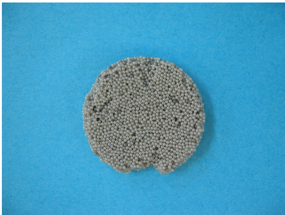
写真 3.3-5 熱伝導度測定試験前の粒子焼結体（ネック比 20%）の外観
