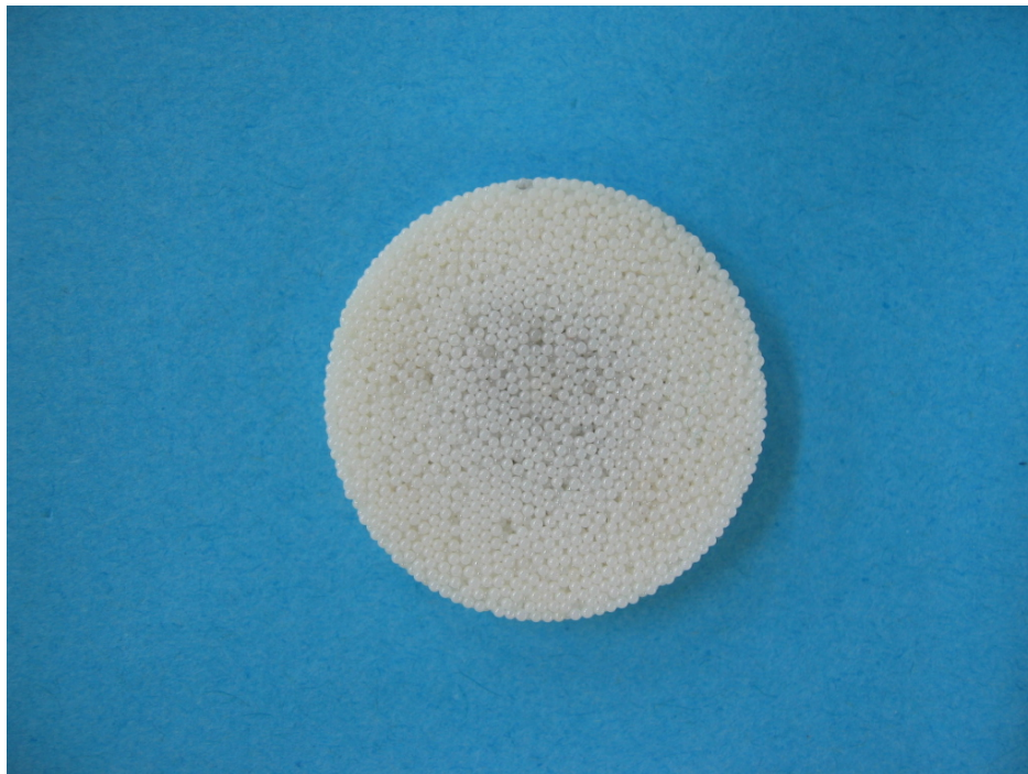
写真 3.3-4 熱伝導度測定試験後の粒子焼結体（ネック比 40%）の外観
