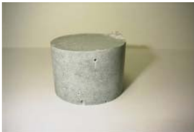
写真 1.12 濃縮度 73.0%の硬化状況（成型 1 日後で硬化）
