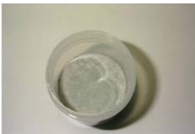
写真 1.3 濃縮度 71.4%のブリージング観察状況 （成型 1 日後でブリージング水なし）
