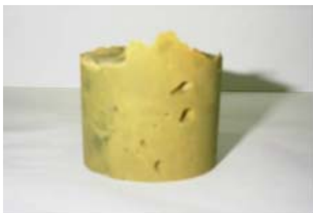
写真 2.24 \text{NaHCO}_3 最大量の硬化状況（成型 1 日後で硬化）
