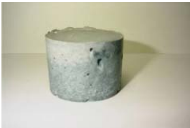
写真 1.16 濃縮度 75.0%の硬化状況（成型 1 日後で硬化）
