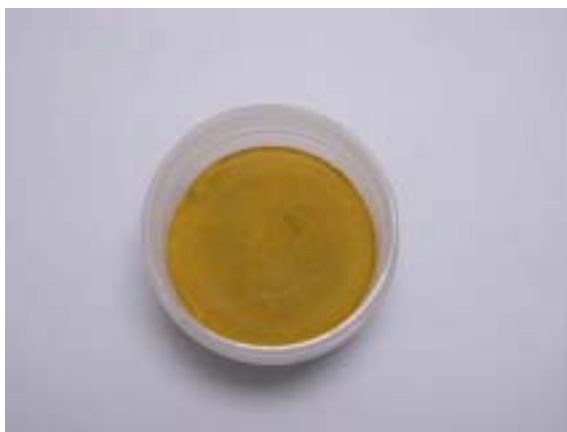
写真 2.11 濃縮度 65.1%のブリージング観察状況 （成型 1 日後でブリージング水なし）
