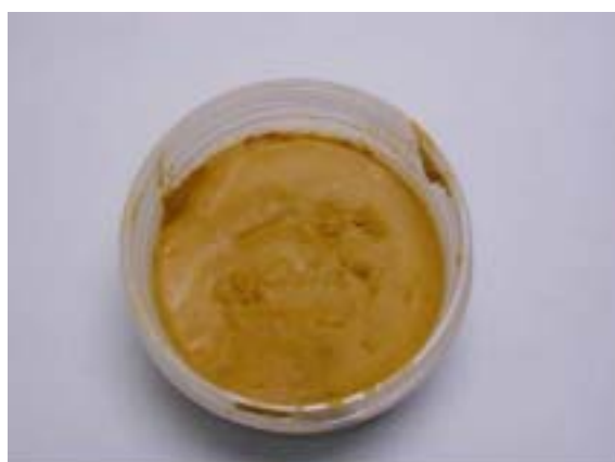
写真 2.3 濃縮度 66.8%のブリージング観察状況 （成型 1 日後でブリージング水なし）
