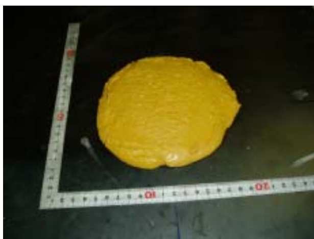
写真 2.22 \text{NaHCO}_3 最大量の混練直後 15 打 JIS フロー値（F15 : 172）
