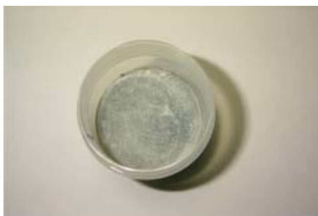
写真 1.19 Na 2 SO 4 量 2 倍 濃縮度 71.4% のフリージング観察状況 (成型後 1 日でフリージング水なし)
