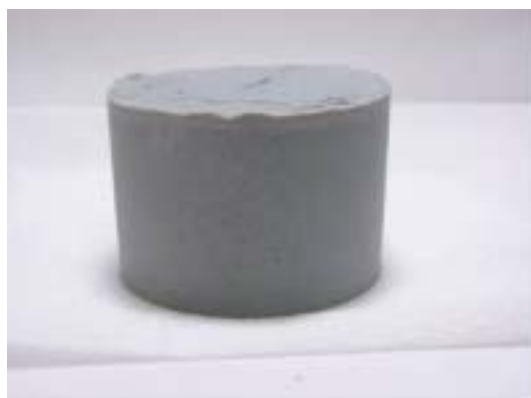
写真 2.31 \text{Na}_2\text{HPO}_4 単独の硬化状況（成型 1 日後で硬化）
