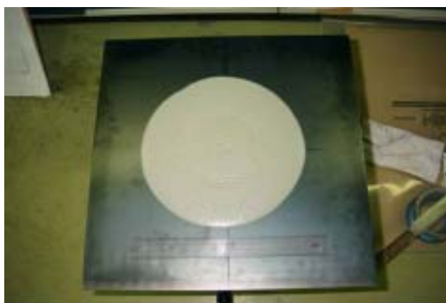
写真 1.2 濃縮度 71.4%の混練直後 15 打 JIS フロー値（F15：266）
