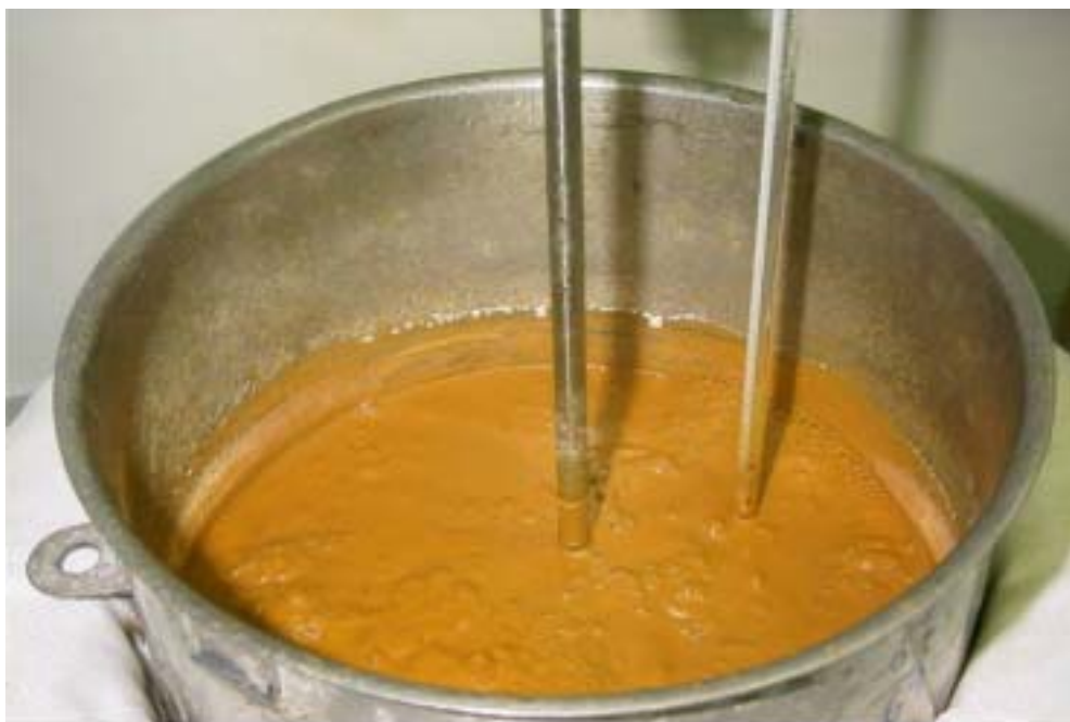
写真 4.4 スラリ廃液の濃縮後(濃縮度 66.8 wt%)
