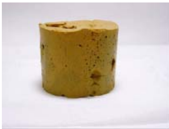
写真 2.4 濃縮度 66.8%の硬化状況（成型 1 日後で硬化）
