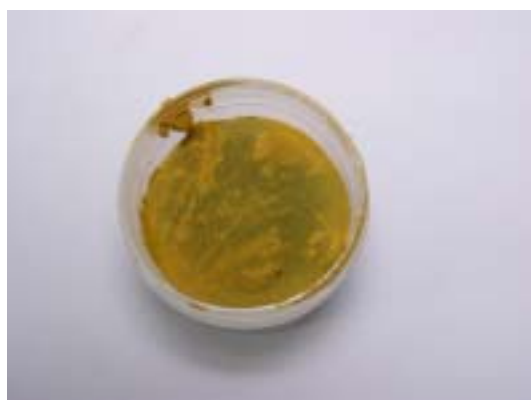
写真 2.15 濃縮度 68.6%のブリージング観察状況 （成型 1 日後でブリージング水なし）
