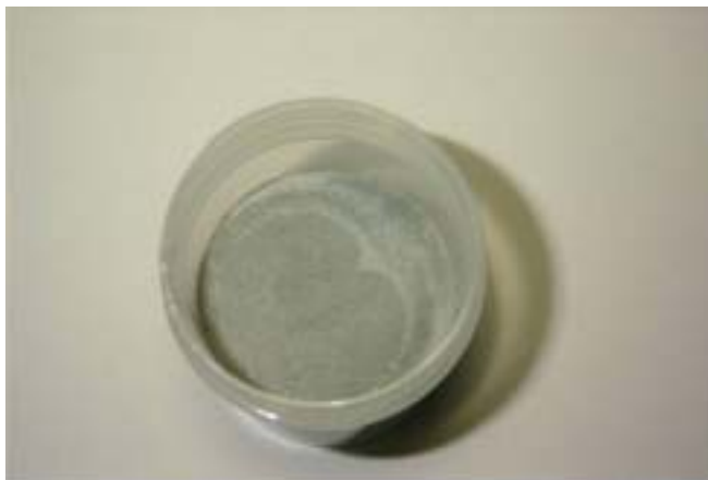
写真 1.15 濃縮度 75.0%のブリージング観察状況 （成型 1 日後でブリージング水なし）
