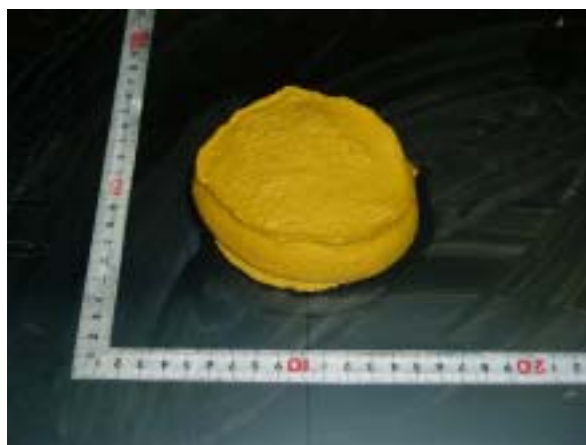
写真 2.13 濃縮度 68.6%の混練直後引抜きフロー値（F0：107）
