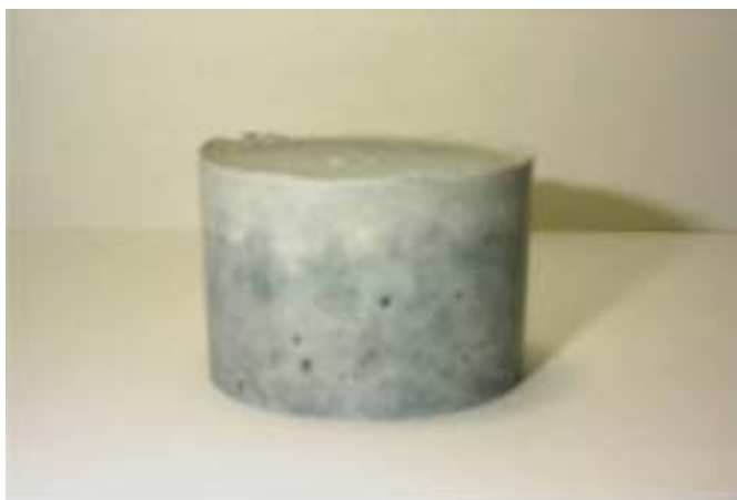
写真 1.20 \text{Na}_2\text{SO}_4 量 2 倍 濃縮度 71.4% の硬化状況 (成型後 1 日で硬化)
