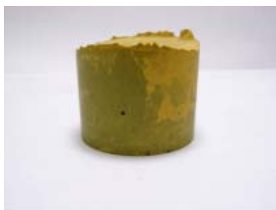
写真 2.28 \text{Na}_2\text{SO}_4 最大量の硬化状況（成型 1 日後で硬化）
