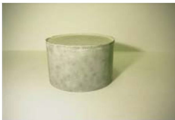
写真 1.8 濃縮度 69.0%の硬化状況（成型 1 日後で硬化）
