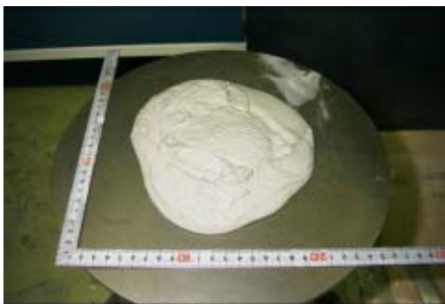
写真 1.17 Na 2 SO 4 量 2 倍 濃縮度 71.4% の混練直後引抜きフロー値 ( F 0 : 156 )
