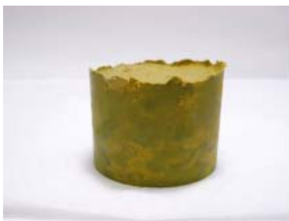
写真 2.8 濃縮度 63.4%の硬化状況（成型 3 日後で硬化）
