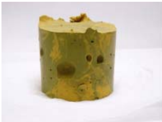
写真 2.16 濃縮度 68.6%の硬化状況（成型 1 日後で硬化）
