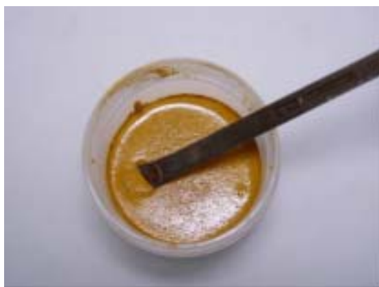
写真 2.7 濃縮度 63.4%のブリージング観察状況 （成型 1 日後でブリージング水なし、ただし未硬化）
