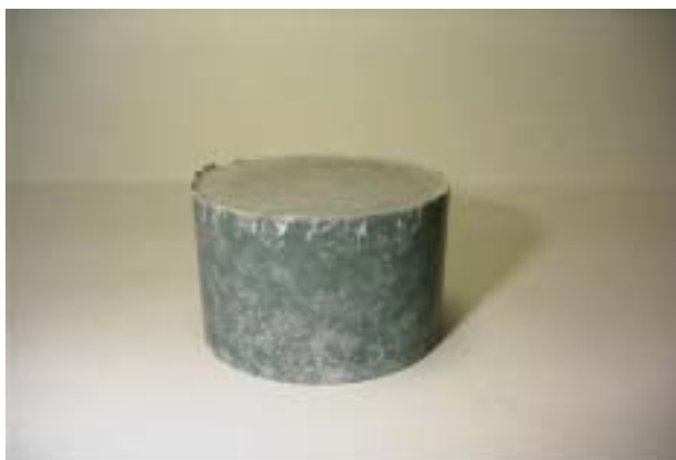
写真 1.4 濃縮度 71.4%の硬化状況（成型 1 日後で硬化）
