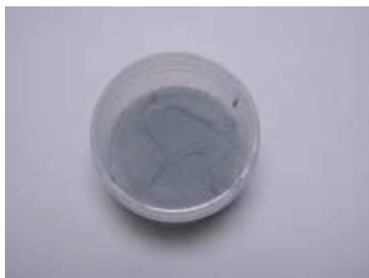
写真 2.30 \text{Na}_2\text{HPO}_4 単独のブリージング観察状況 （成型 1 日後でブリージング水なし）
