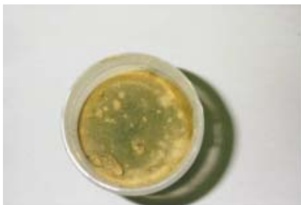
写真 2.23 \text{NaHCO}_3 最大量のフリージング観察状況 （成型 1 日後でフリージング水なし）
