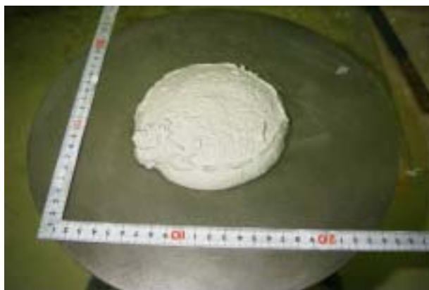
写真 1.13 濃縮度 75.0%の混練直後引抜きフロー値（F0 : 112）
