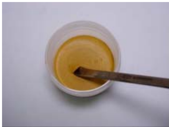
写真 2.19 \text{NaNO}_2 最大量のフリージング観察状況 （成型 1 日後でフリージング水なし、ただし未硬化）
