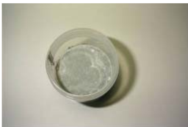
写真 1.11 濃縮度 73.0%のブリージング観察状況 （成型 1 日後でブリージング水なし）
