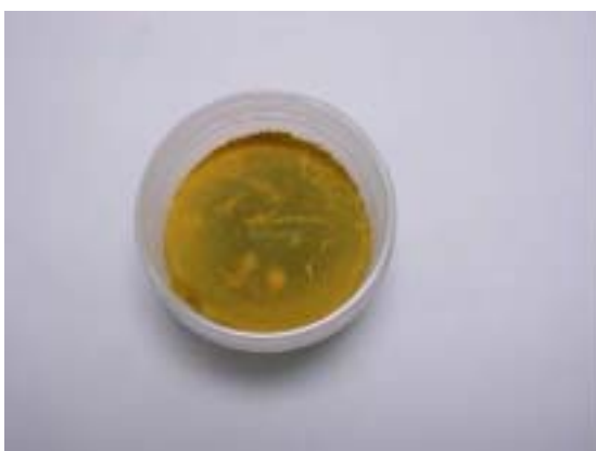
写真 2.27 \text{Na}_2\text{SO}_4 最大量のブリージング観察状況 （成型 1 日後でブリージング水なし）
