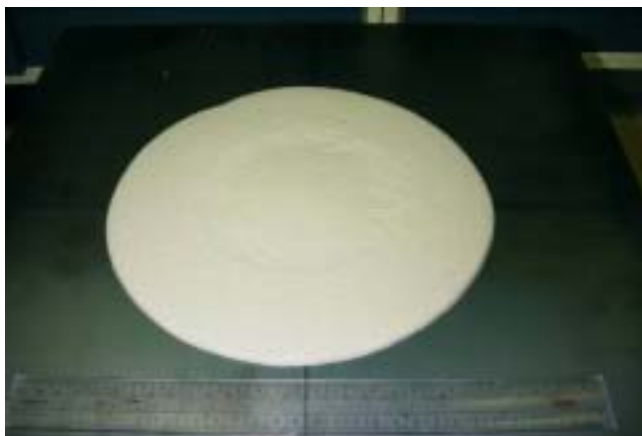
写真 1.1 濃縮度 71.4%の混練直後引抜きフロー値（F0：244）
