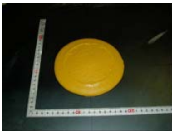
写真 2.1 濃縮度 66.8%の混練直後引抜きフロー値（F0：152）
