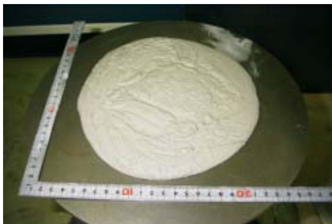
写真 1.18 Na 2 SO 4 量 2 倍 濃縮度 71.4% の混練直後 15 打 JIS フロー値 ( F 15 : 190 )
