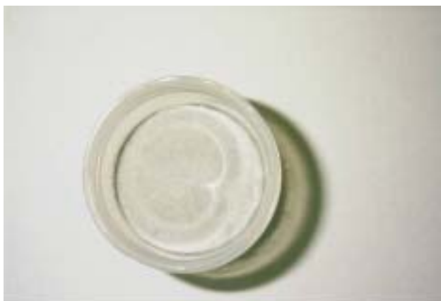
写真 1.7 濃縮度 69.0%のブリージング観察状況 （成型 1 日後でブリージング水なし）
