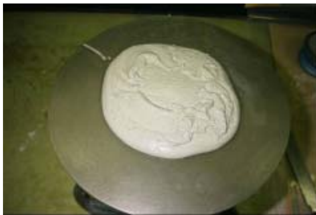
写真 1.9 濃縮度 73.0%の混練直後引抜きフロー値（F0：178）
