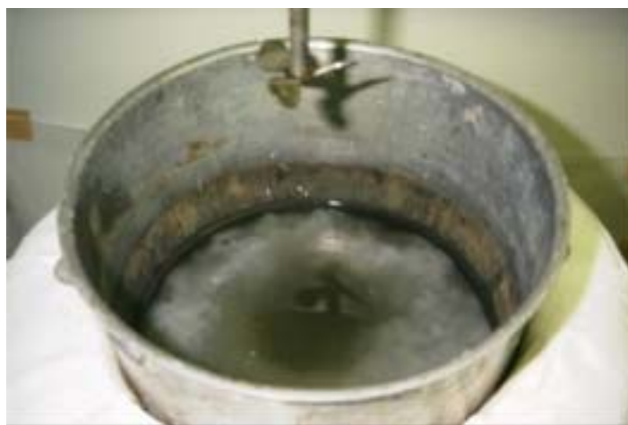
写真 4.2 硝酸塩廃液の濃縮後(濃縮度 71.4 wt%)
