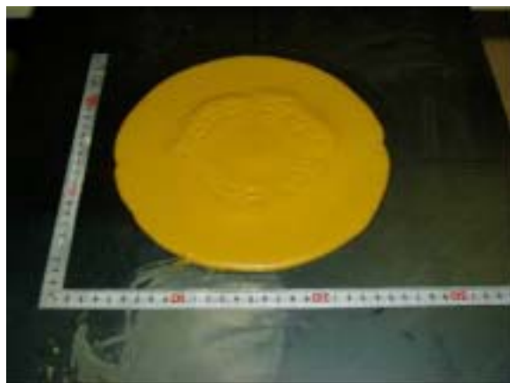
写真 2.17 \text{NaNO}_2 最大量の混練直後引抜きフロー値（F 0 : 230）
