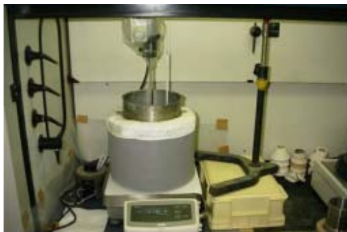
写真 4.1 濃縮試験装置外観
