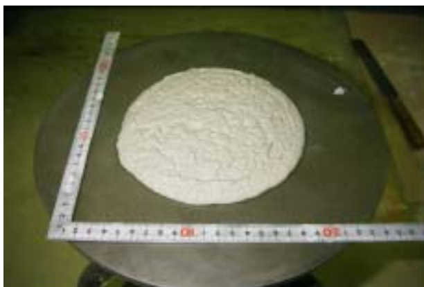
写真 1.14 濃縮度 75.0%の混練直後 15 打 JIS フロー値（F15 : 154）
