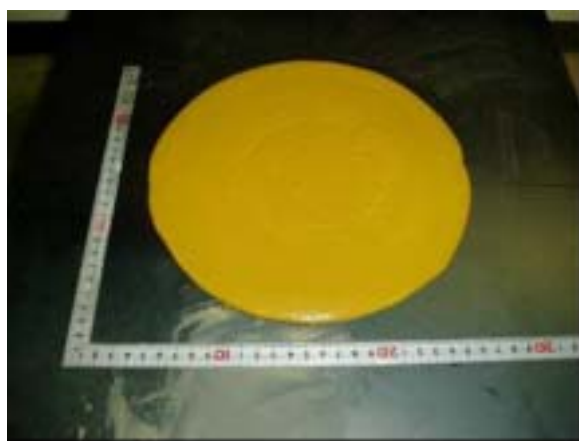
写真 2.18 \text{NaNO}_2 最大量の混練直後 15 打 JIS フロー値（F 15 : 238）
