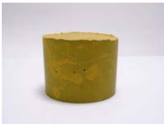
写真 2.12 濃縮度 65.1%の硬化状況（成型 1 日後で硬化）
