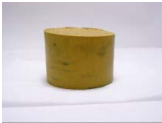
写真 2.20 \text{NaNO}_2 最大量の硬化状況（成型 3 日後で硬化）
