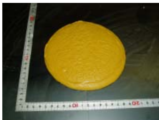
写真 2.14 濃縮度 68.6%の混練直後 15 打 JIS フロー値（F15：154）
