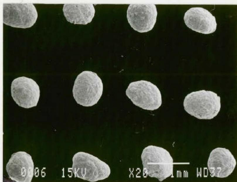
写真 3.1 粒子① (粒径 : 600~710 $\mu$ m) の外観SEM写真
