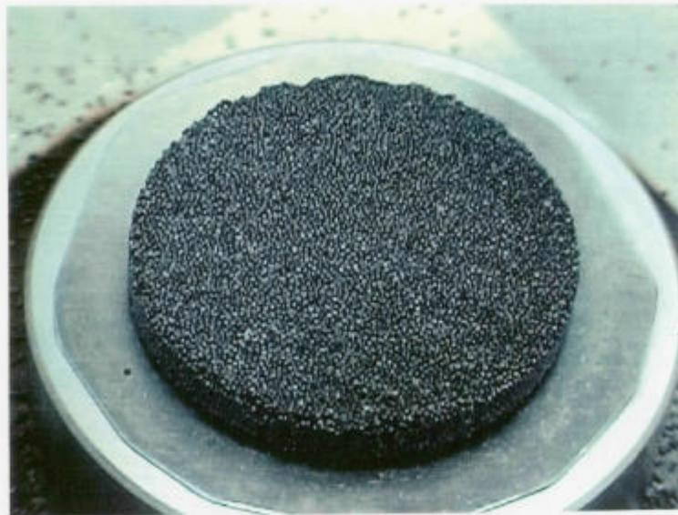
写真 3.2 先行試験後の粒子充填層の固着状況（2）
