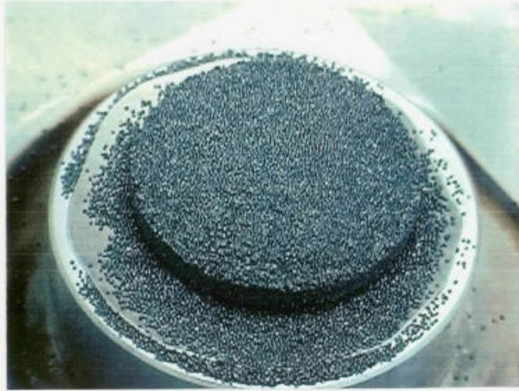
写真 3.1 先行試験後の粒子充填層の固着状況（1）
