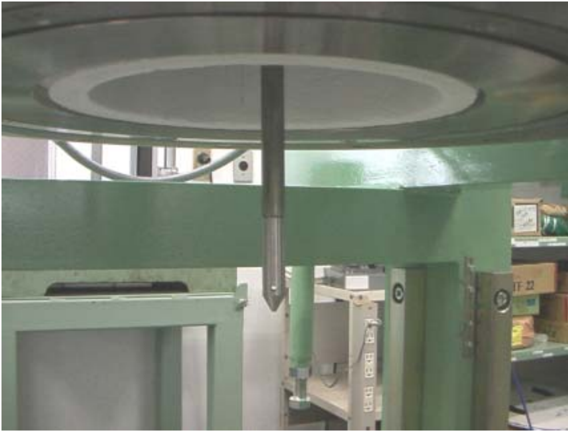
図 3.1-6 焙焼ガス・還元ガス供給ロッド
