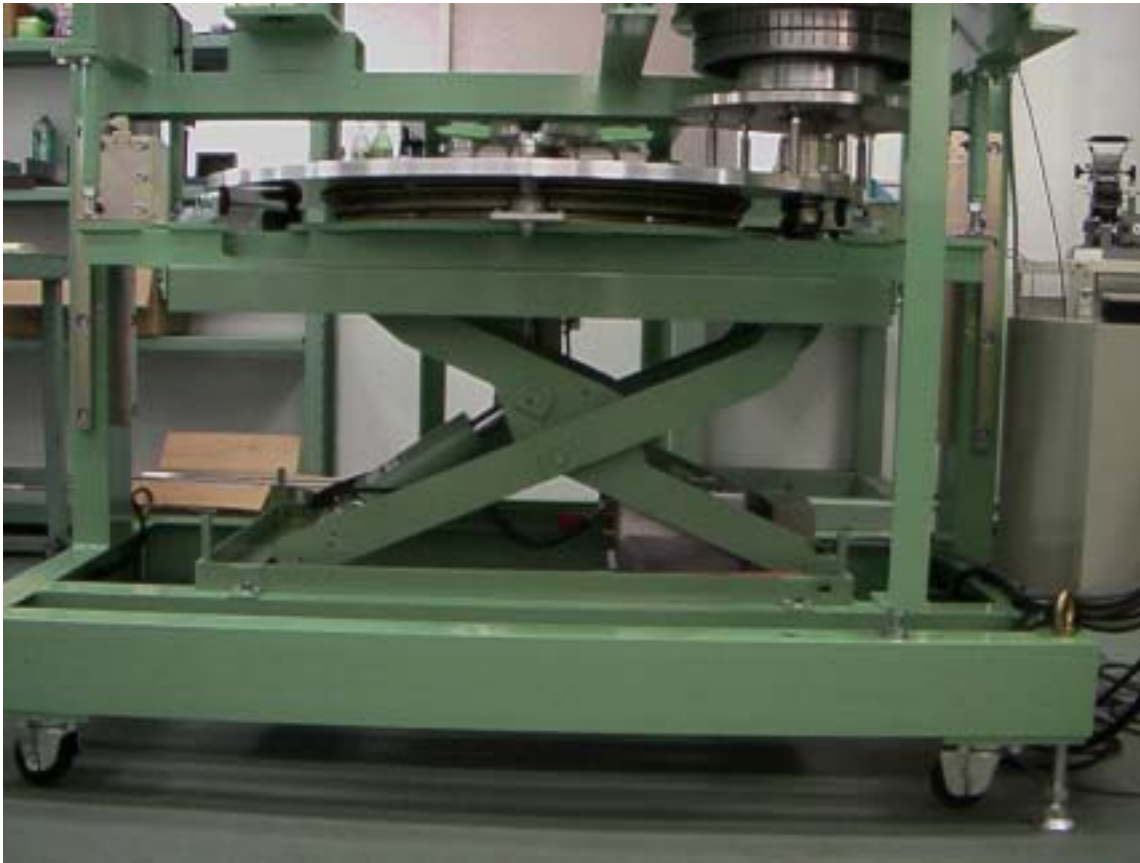
図 3.1-8 ターンテーブル昇降装置(シザーリフト)
