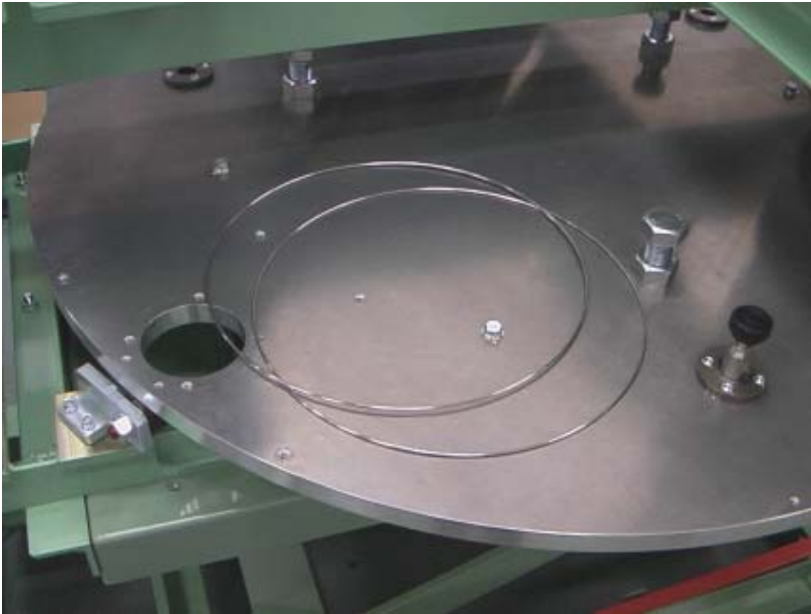
図 3.1-4 金属 O リング(還元炉シール用)
