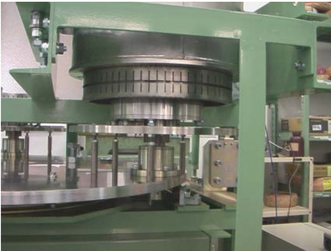
图 3.1-3 焙烧還元炉と脱硝容器設置台
