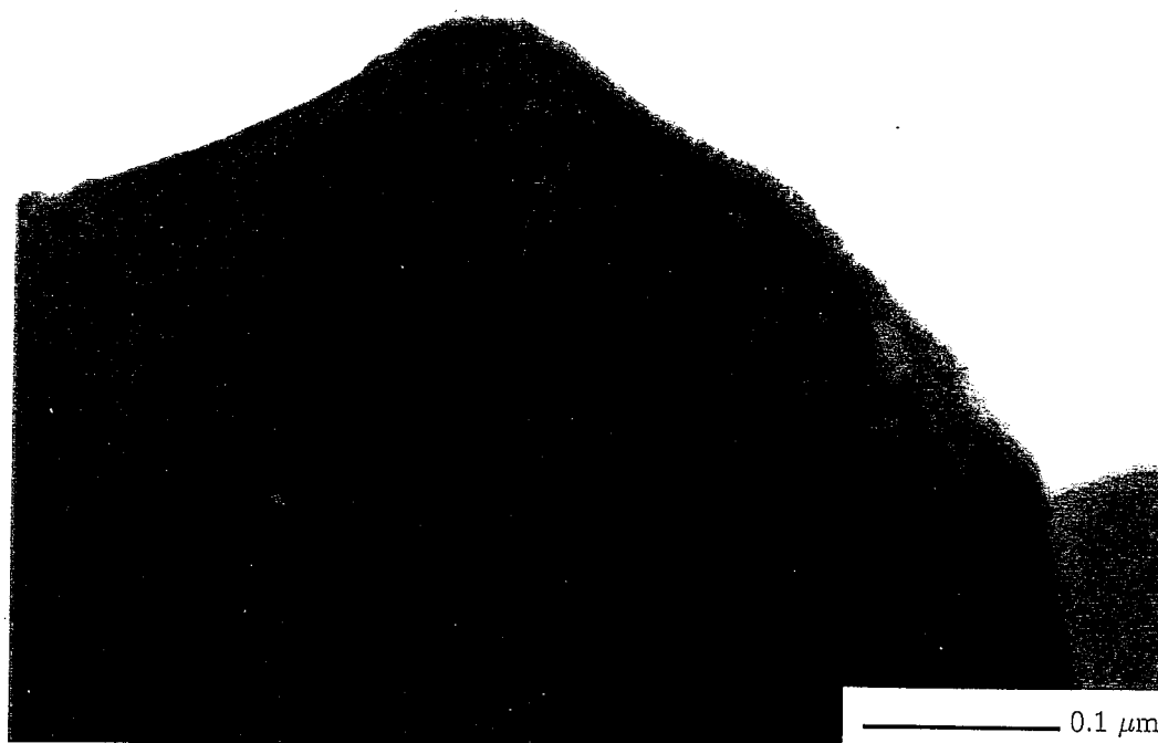
図26 SiCの 3.9 \times 10^{26} \text{ n/m}^2 、620℃照射試料の電子顕微鏡写真
