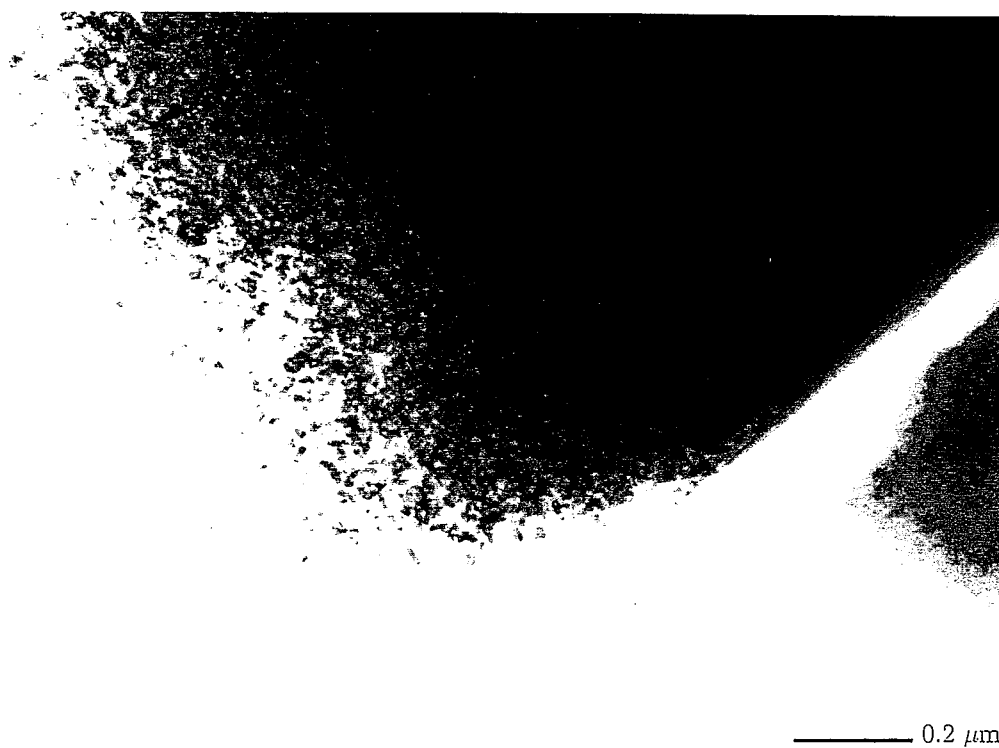
図22 AlNの 3.7 \times 10^{26} \text{ n/m}^2 、727℃照射試料の電子顕微鏡写真
