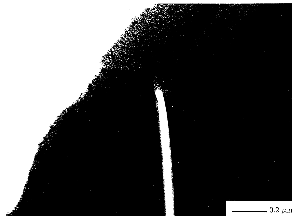
図18 AlNの 3.9 \times 10^{26} \text{ n/m}^2 、620℃照射試料の電子顕微鏡写真
