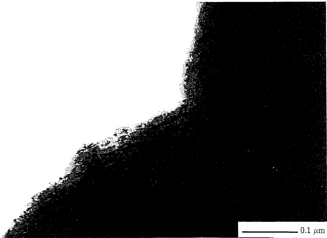
図19 AlNの 3.9 \times 10^{26} \text{ n/m}^2 、620℃照射試料の電子顕微鏡写真
