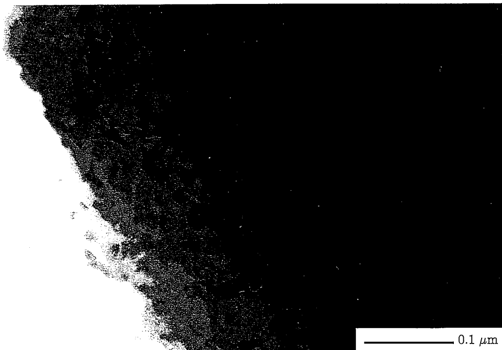
図34 Si 3 N 4 の 3.9 \times 10^{26} \text{ n/m}^2 、620℃照射試料の電子顕微鏡写真
