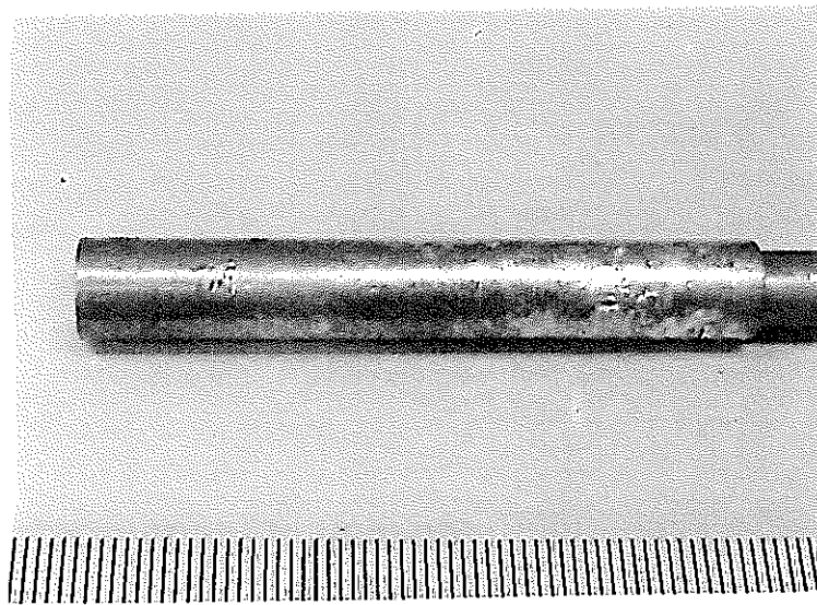
写真1.16 急冷試験後のガスギャップ（A型）試験体
