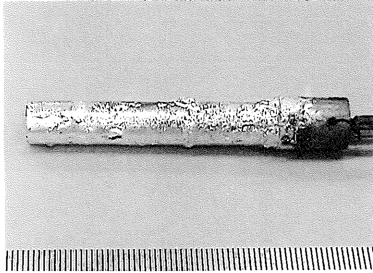
写真1.9 急冷試験後の織布装荷試験体（織布圧縮率:10%）
