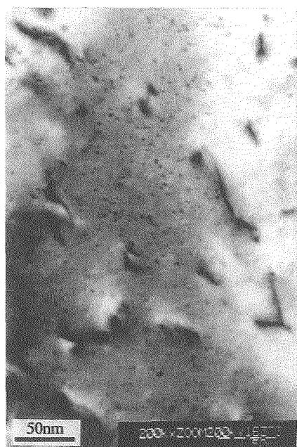
図7 ODSフェライト鋼被覆管（F4試料）の透過型電子顕微鏡写真
