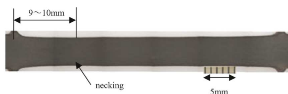
写真4 三次クリープ域内（1269時間）で中断させた試験片の外観観察結果
