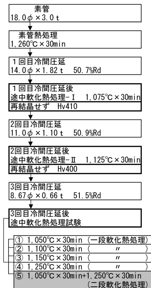
図6 ODSフェライト鋼の二段軟化熱処理試験フロー
