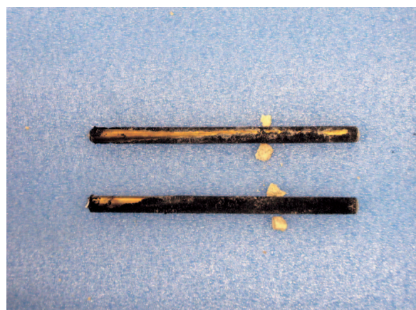
写真1 乾燥後の供試体M1002から採取した電極（黒い物質は導電性シリコン。付着していない箇所がある）
