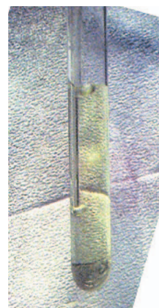
図6 \text{UO}_2\text{Cl}_2 を含むNaCl・2CsCl溶融塩
