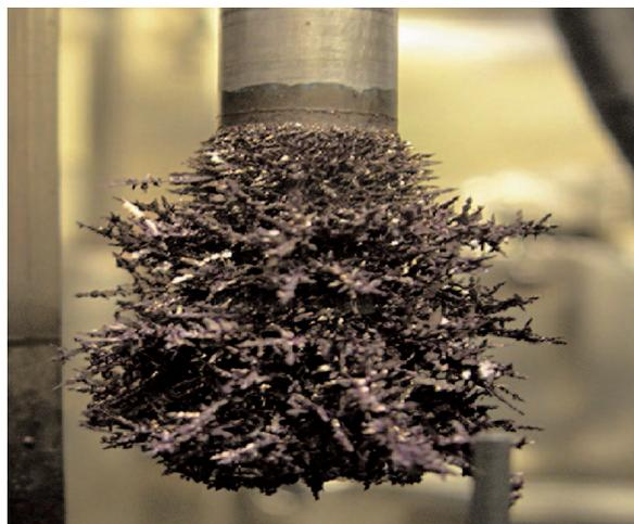
写真1 ウラン試験で回収した dendroid 状金属ウラン
