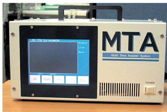
写真1 時間間隔解析機能付きサーベイメータ本体
