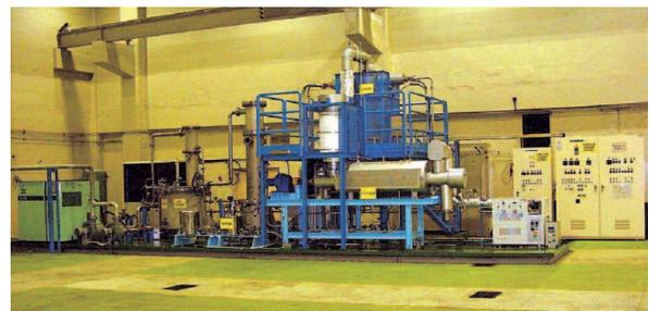
写真1 移設後の水蒸気改質処理試験装置
