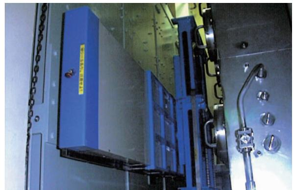
写真5 改良されたホールドアップ測定装置
