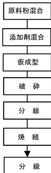
図4 バイバック顆粒のプロセスフロー
