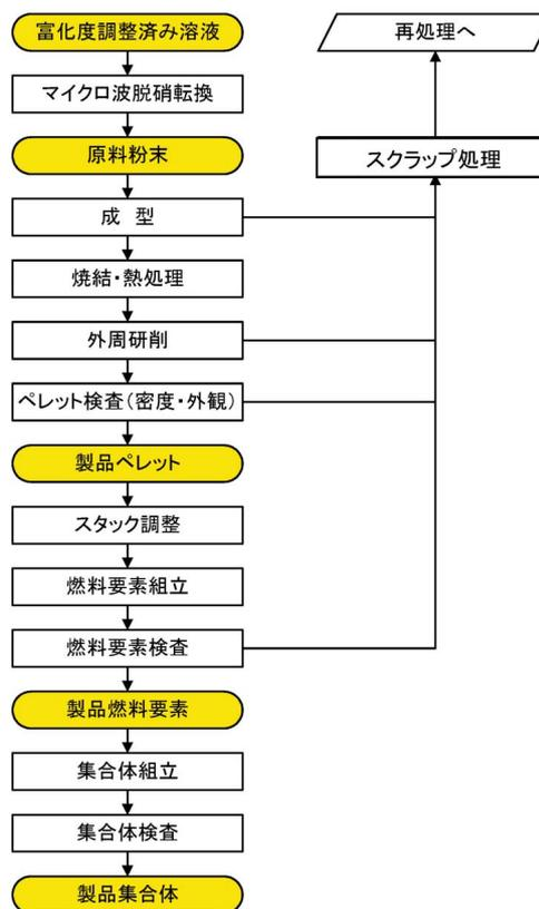
図2 簡素化ペレット法におけるプロセスフロー
