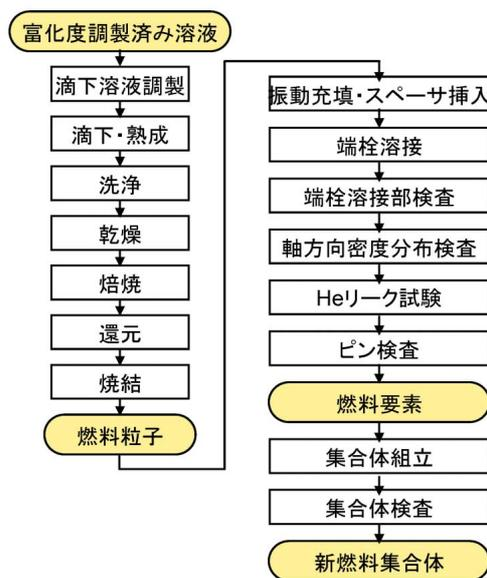
図4 スフェアバック法におけるプロセスフロー
