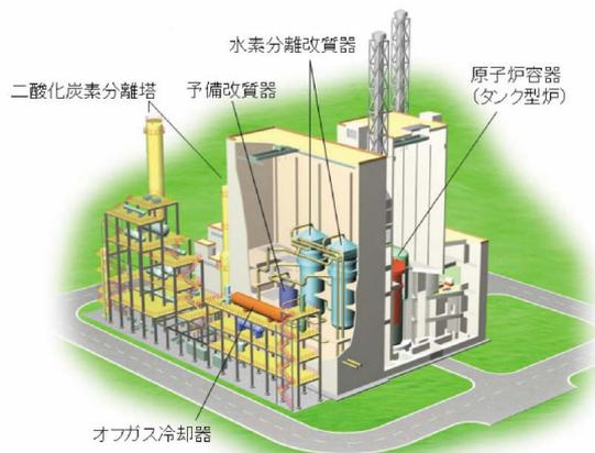
図18 水素分離改質法を用いた水素製造プラント鳥瞰図
