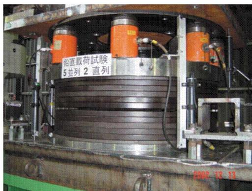
図18 実大皿ばねの力学特性試験の様子
