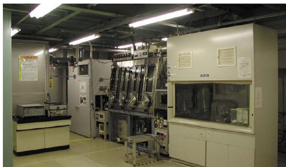
図8 溶融塩電解試験設備
