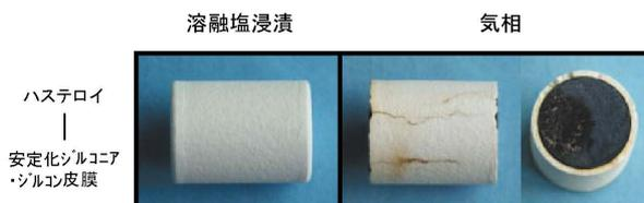
図31 塩素・酸素雰囲気における暴露試験後の外観観察結果
