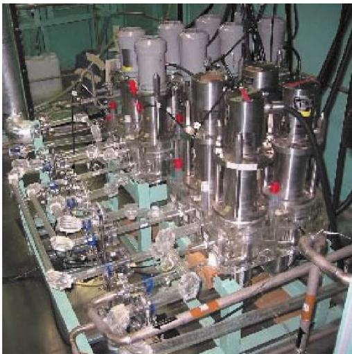
写真2 遠心抽出器システム試験装置 (逆抽出工程)
