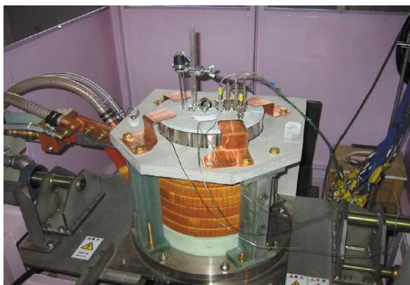
図26 円環型誘導加熱式電解槽
