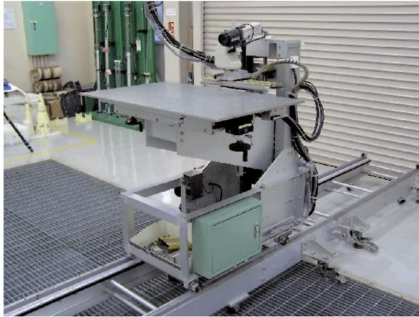
図1 被校正器を設置する校正台車（材質：主にAl）
