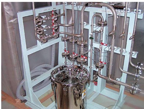
写真1 トリチウム除去試験装置
