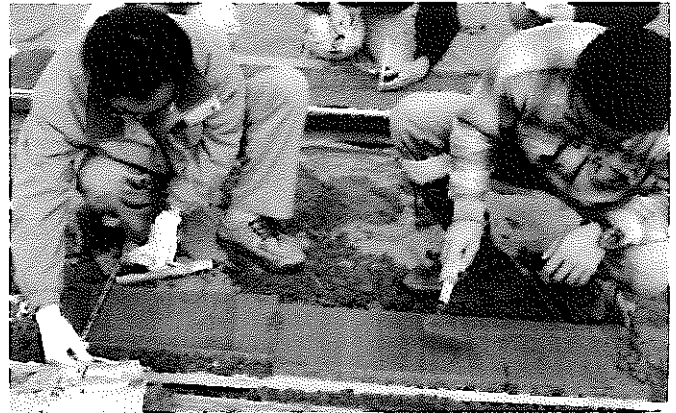
Fig. 10 サンプルは観察サイトに運び、ねじり鎌等で表面整形した後観察する。また、必要に応じて保存用のケースにサンプルを移し、そのまま保管することもできる。
