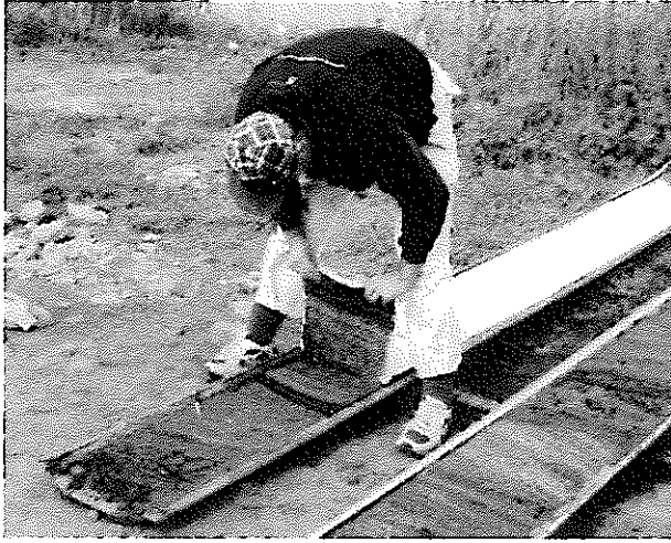
Fig. 9 サンプルの保管に関しては、剥ぎ取り試料 (Peel-sample) の作成も行う。サンプルを横置きにすることで、垂直壁面の剥ぎ取りに比べ非常に容易に作業を行うことができる。砂質の堆積物では簡便なスプレー糊を用いた方法も有効である。本調査時にはグラウチングに使用される樹脂 (OH-1 東邦化学製) を用いることで、堆積物の粒度の違いを気にすることなく良質の剥ぎ取り保存資料を得ている。
