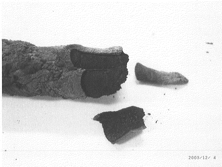
図10 陰極堆積物表面から外壳を外した様子
