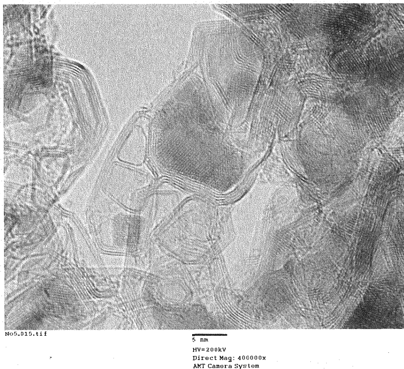
図 37 2200°C熱処理後のランタンフラーレン煤(E)の高分解能 TEM 写真II
