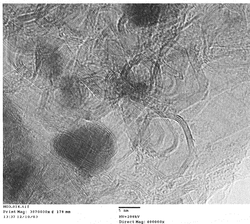
図 23 アーク放電試験バッチ⑥の陰極堆積物芯部分の高分解能 TEM 写真Ⅲ
