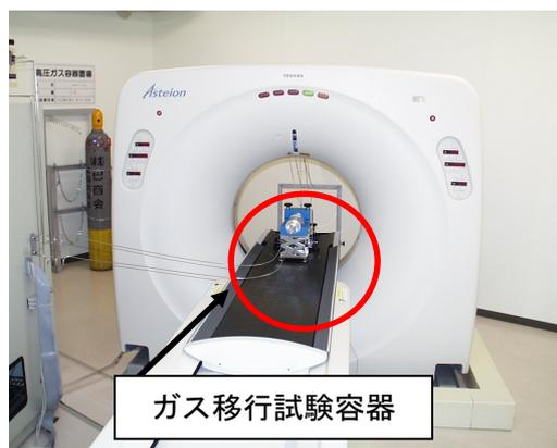
図 3.3.1-3 X 線 CT スキャナの概観
