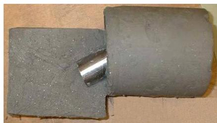
図 3.3.2-7 緩衝材中の模擬オーバーパックの回転状況（試験 1）
