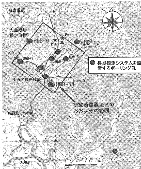
長期観測システムを設置する ボーリング孔位置 (掘削深度500~1000m程度)
