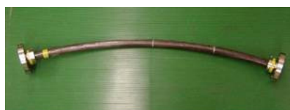
溶接フランジ型基準試験片
