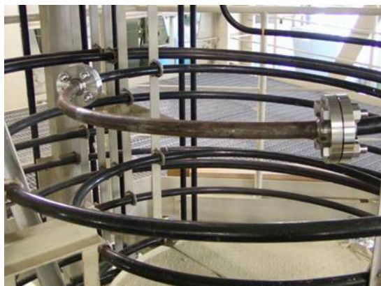
基準試験片の設置状況
