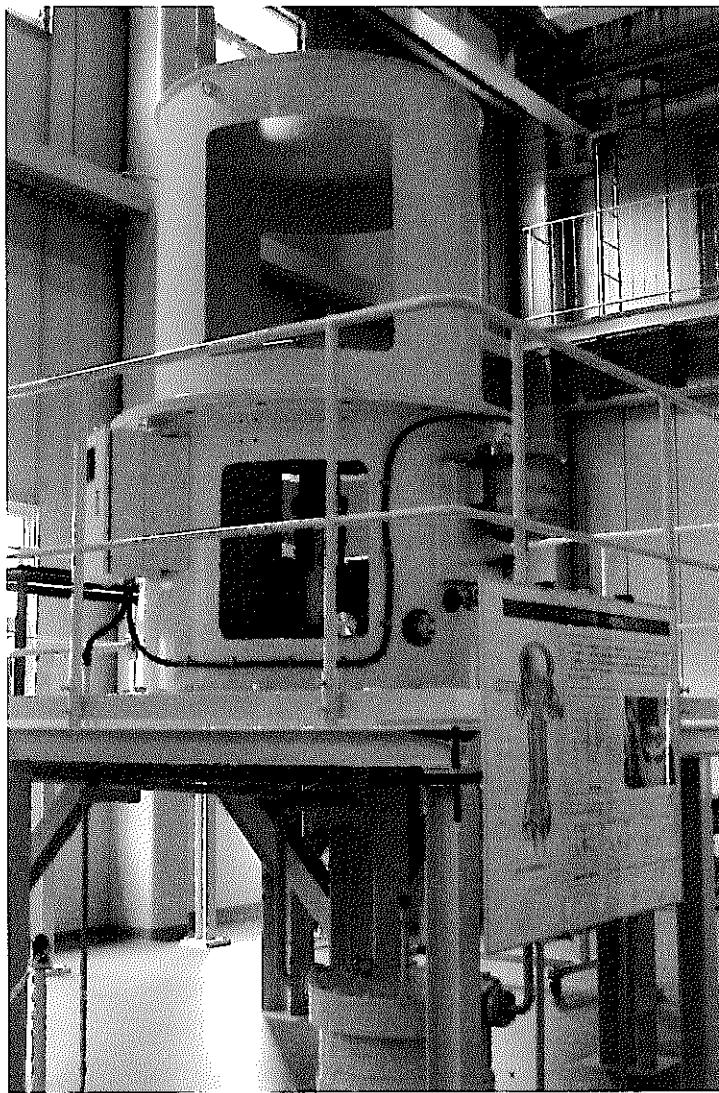
写真-5 二次主循環ポンプ軸封部学習モデル
