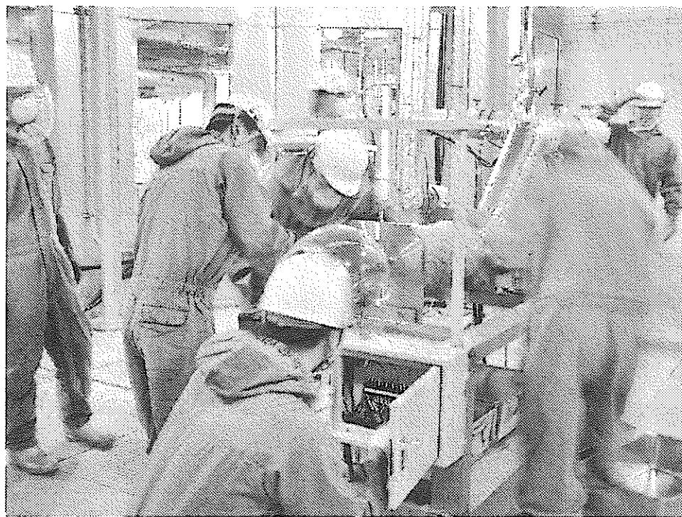
写真2 ナトリウム漏洩実験後の模擬配管解体状況
