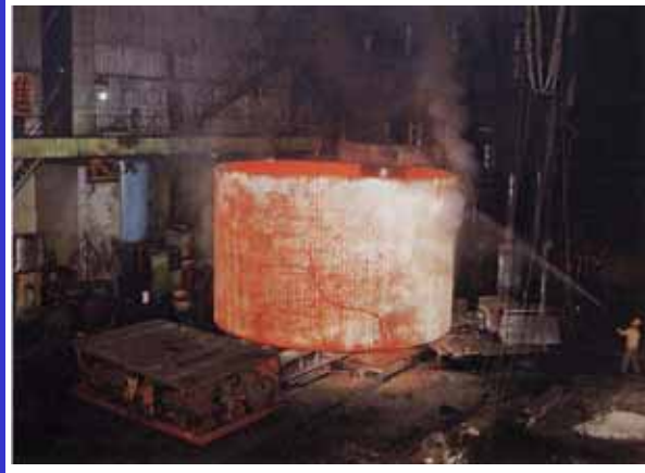
写真4-2 鍛錬 (中間胴(上部)部材の機外での穴拡げ)
