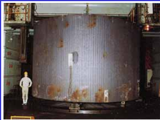
写真4-3 機械加工(黒皮削り段階)
