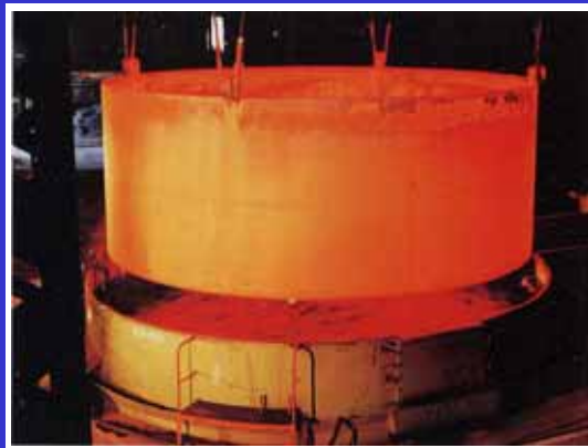
写真4-4 固溶化熱処理
