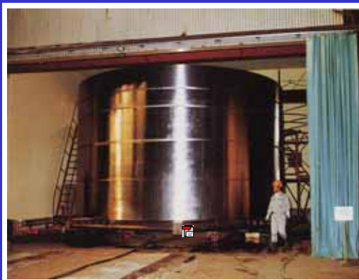
写真4-5 最終検査（超音波探傷検査）
