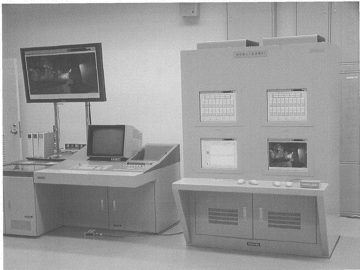
図-7 総合漏えい監視盤模擬盤（向かって右側直立盤及び大型ディスプレイ装置）
