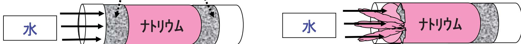
◆アルコール洗浄は水に比べてマイルドな反応であるので、水による最終洗浄処理の前処理として使用することがある。アルコールはナトリウムと反応すると水溶性のアルコラートと呼ばれる塩基性の化合物を生成する。
