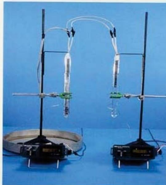
熱の伝わり方の実験(ナトリウム(左)、水(右))
