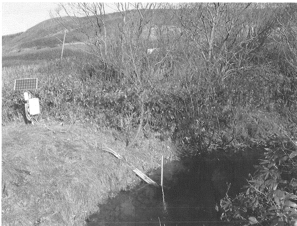
写真 3.3 河川流量観測システム設置例 (P-2 地点)
