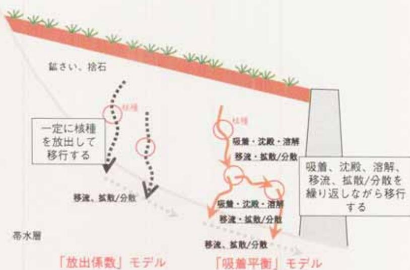
図 4.4-1 NESTOR 解析における 2 種類のモデル図 (サイクル機構、2002)
