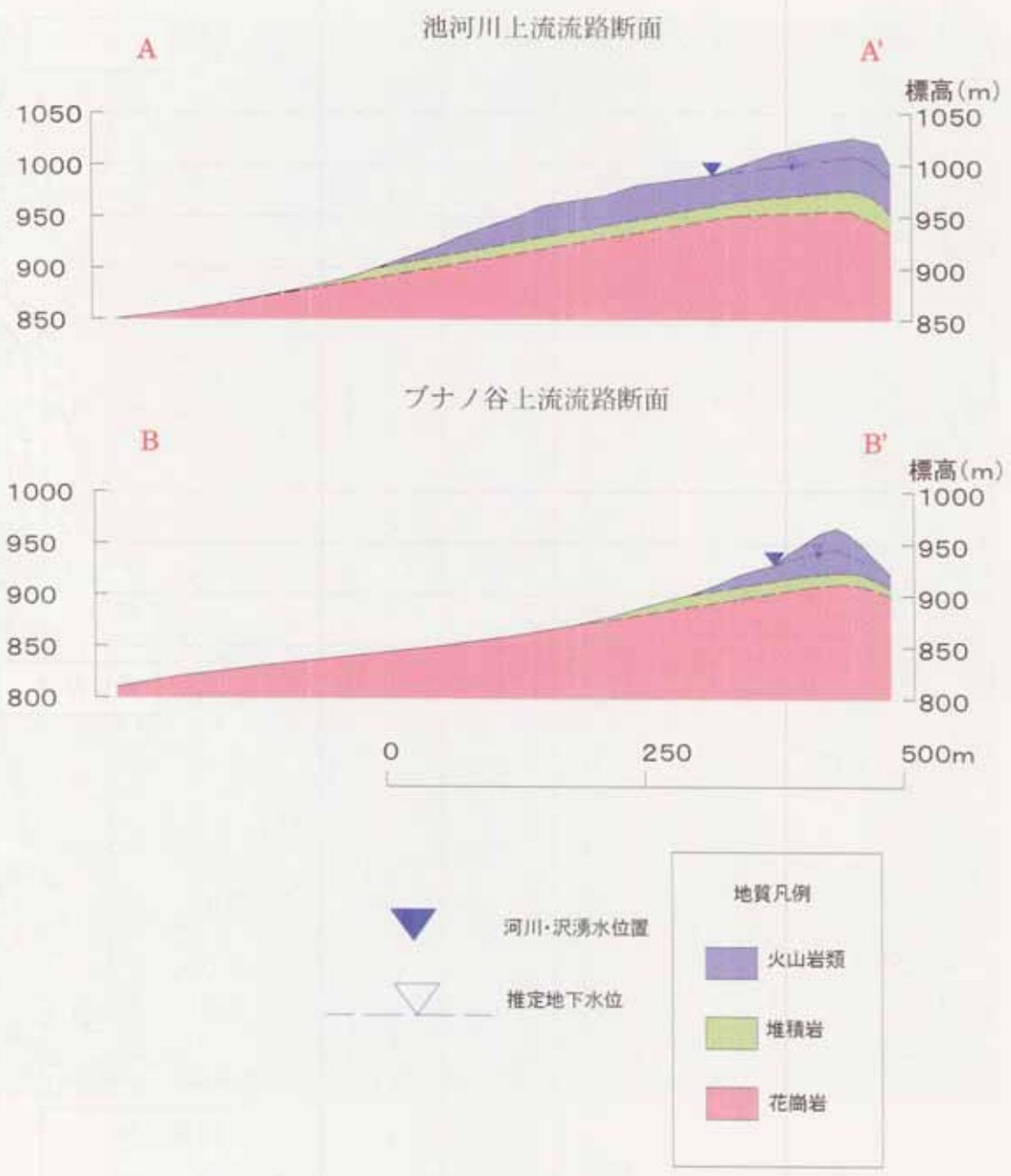
図 3.1-3 地質および地下水位推定断面
