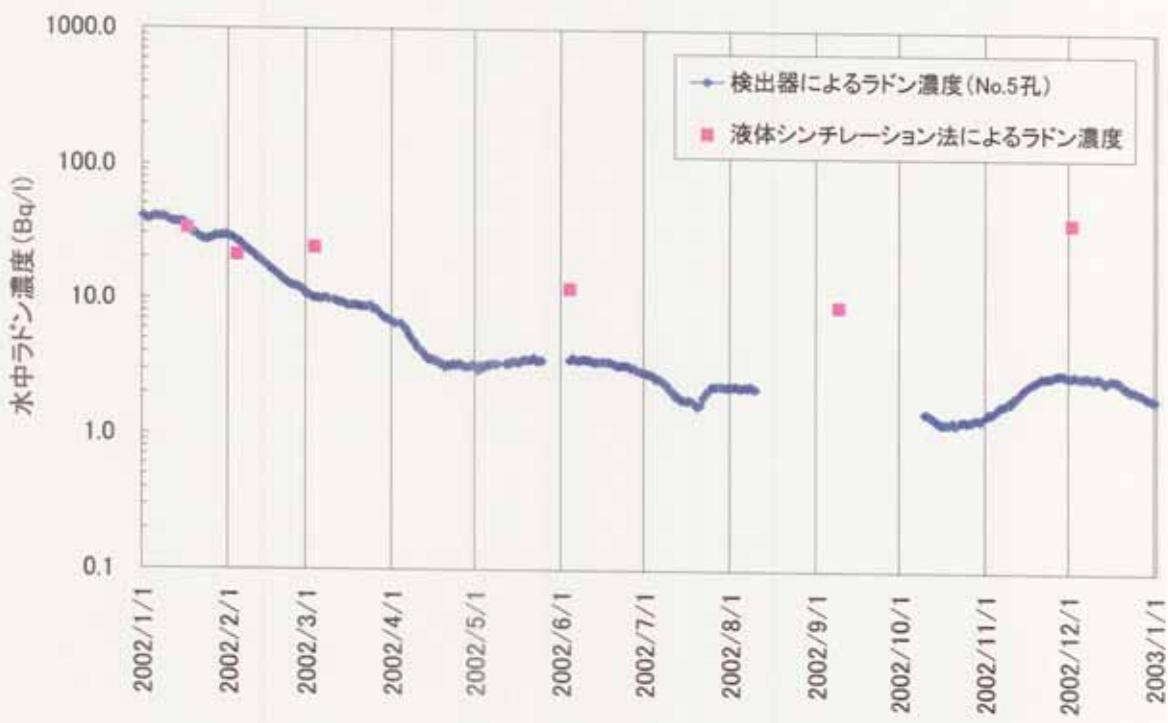
付図 6.1-14 No.5 孔水中ラドン濃度の測定結果（2002 年）
