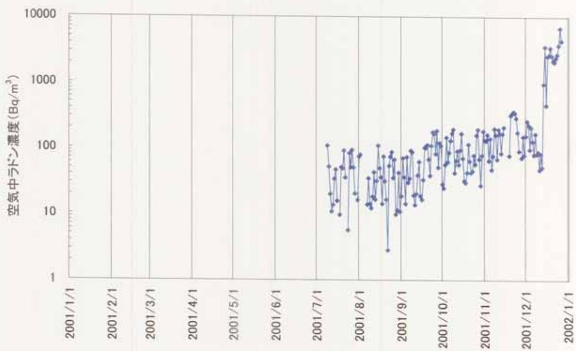
付図 6.2・4 No.19 孔コンテナハウス内の空気中ラドン濃度測定結果（2001 年）
