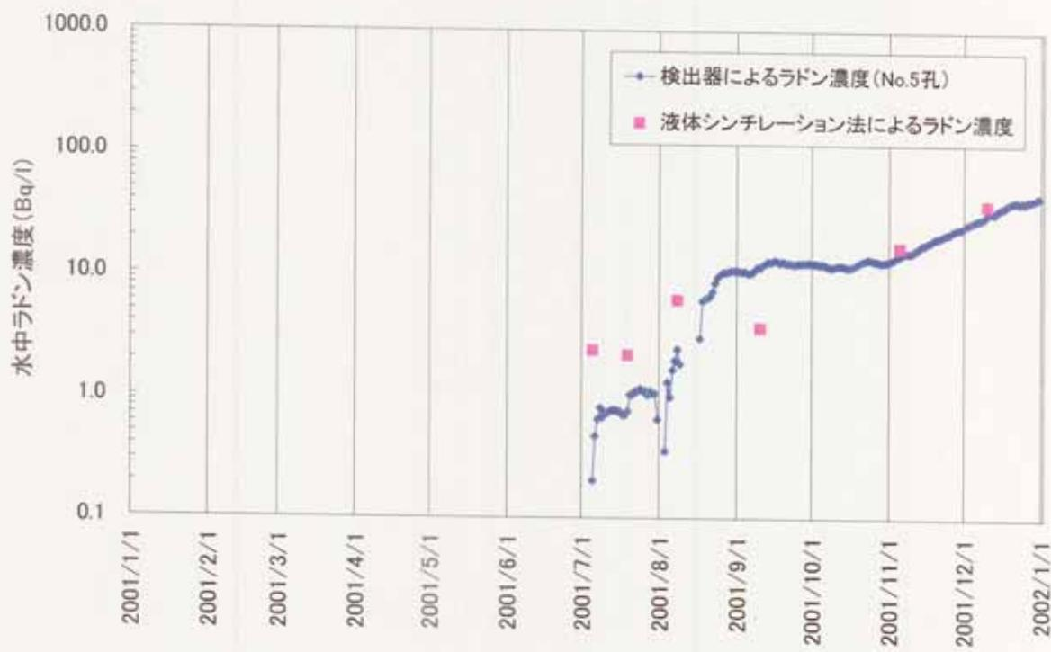
付図 6.1-13 No.5 孔水中ラドン濃度測定結果（2001 年）
