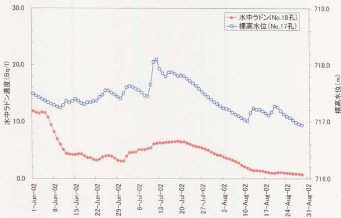
図3.1.3-1 No.18孔水中ラドン濃度とNo.17孔標高水位の測定結果
