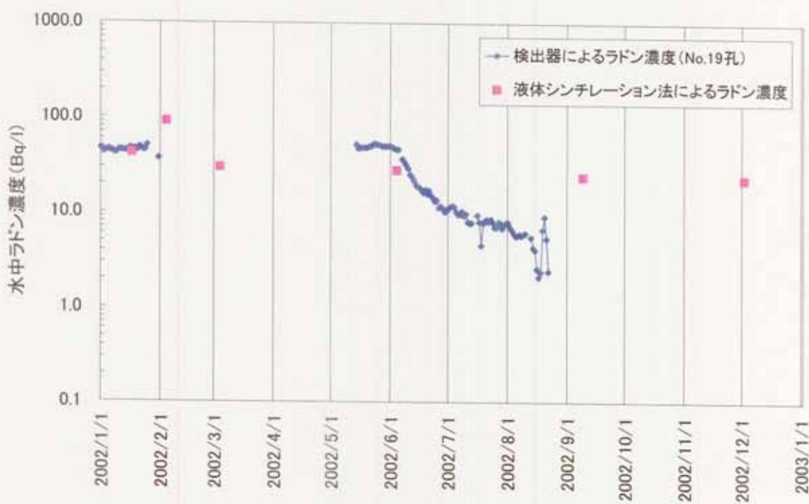
付図 6.1-9 No.19 孔水中ラドン濃度測定結果（2002 年）
