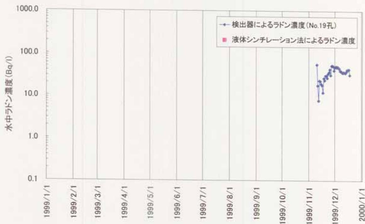
付図 6.1-6 No.19 孔水中ラドン濃度測定結果（1999 年）
