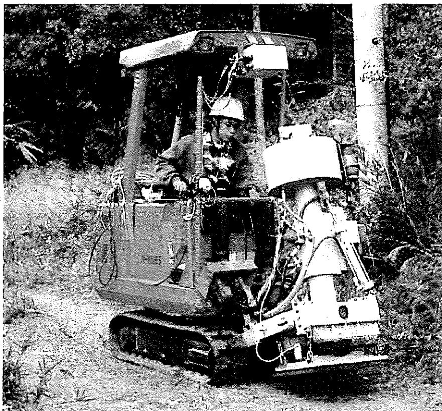
図3.2.10 小型油圧インパクター（反射法弾性波探査）
