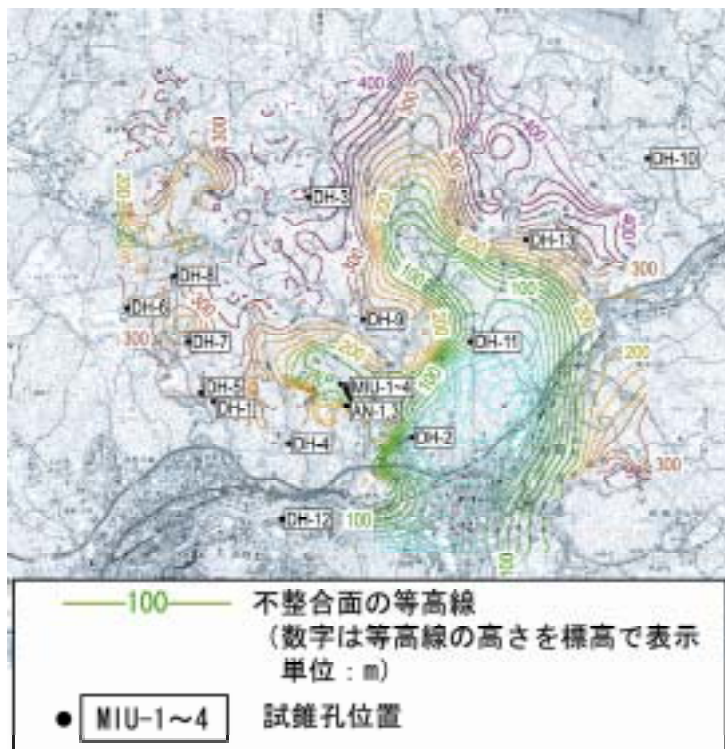
図2 堆積岩と基盤花崗岩の不整合面の等高線図
