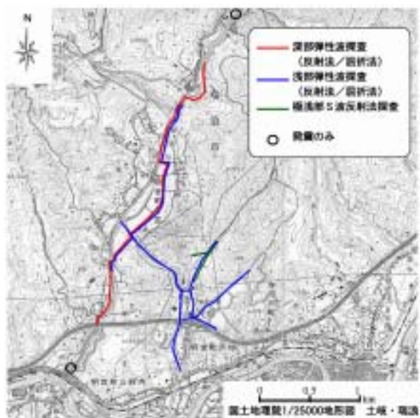
図9 反射法弾性波探査の測線位置
