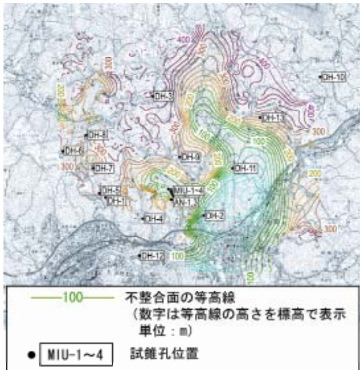
図8 堆積岩と基盤花崗岩の不整合面の等高線図
