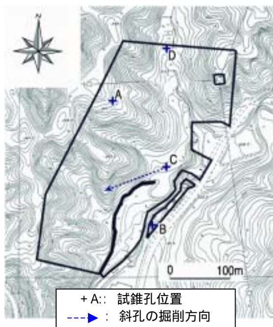
図10 浅層試錐調査の試錐孔位置図
