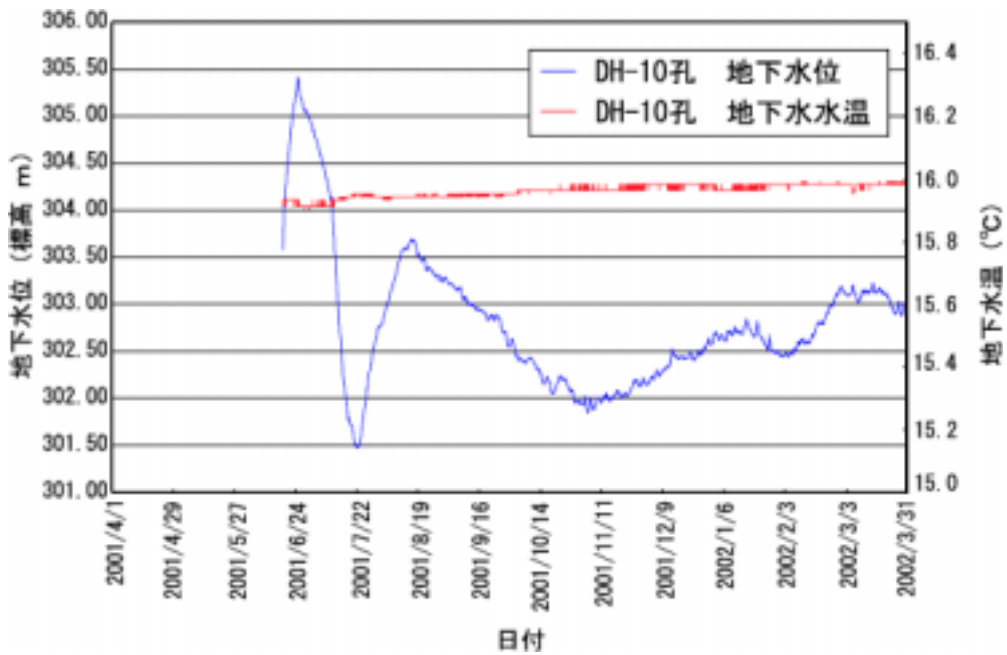
図 5.4.5 DH-10 号孔における地下水位と地下水水温の経時変化
