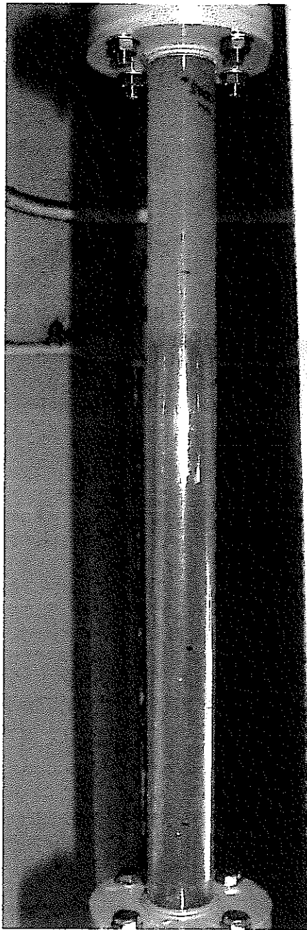
図5.5.5-4 配管内の気液混合流の様子 (砲弾形気泡、溶液密度：1.0 g/cm 3 ) (赤インクにて着色)
