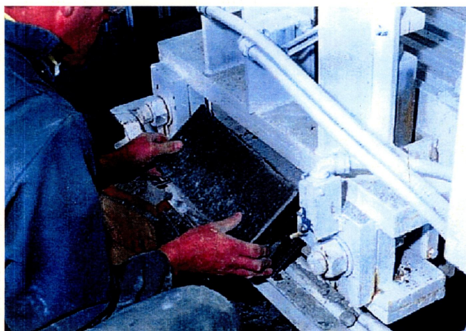
図-4.10 粘土ブロックの圧縮成型
