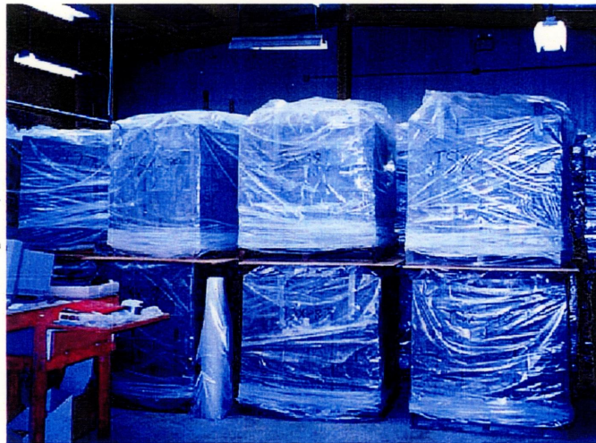
図-4.11 粘土ブロックの養生
